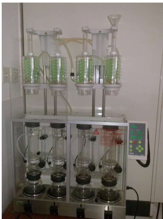
Slika 10: Soxhletov aparat za ekstrakcijo vzorcev Büchi B-811
