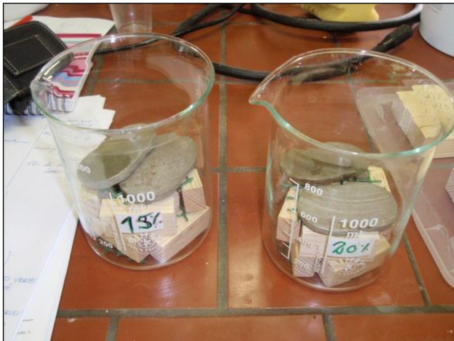
Slika 9: Obteženi vzorci pripravljeni na postopek vakuumske impregnacije
