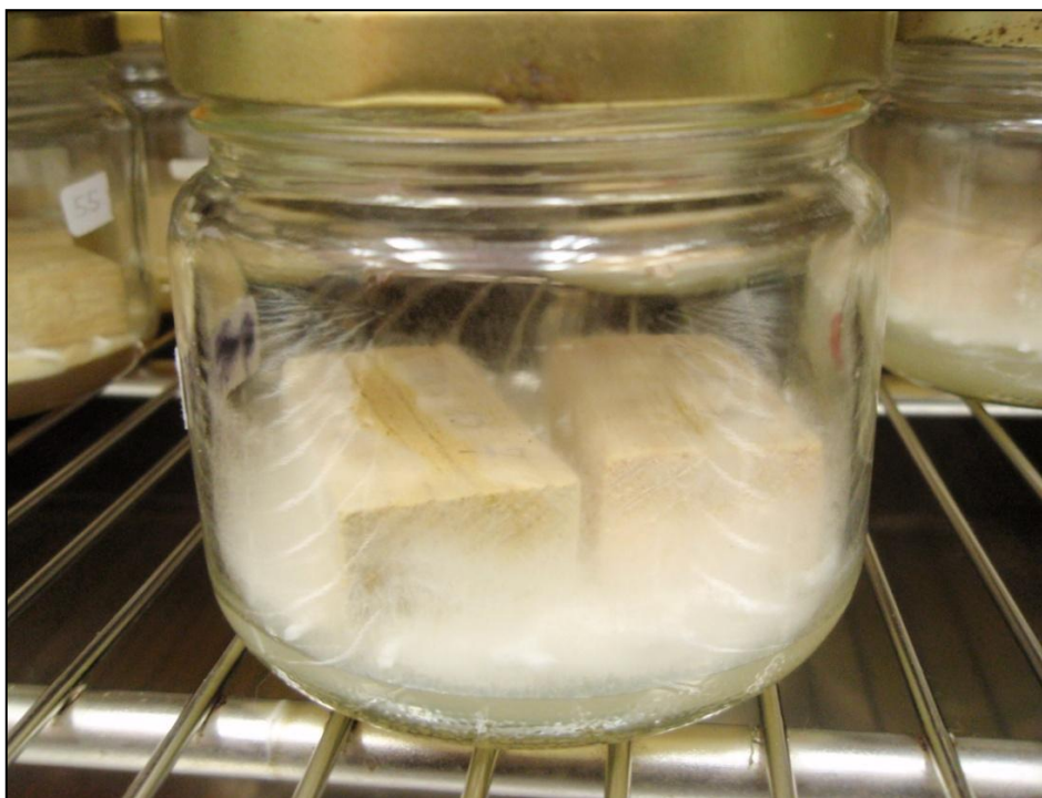
Slika 11: Kozarec z vzorci v gojitveni komori, vatni filter na sliki ni viden
