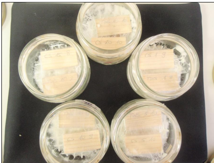
Slika 12: Preraščeni vzorci izpostavljeni beli hišni gobi
