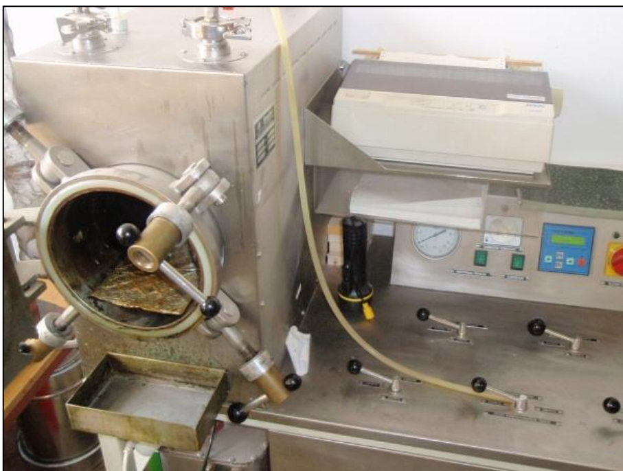
Slika 10: Vakuumska komora za impregnacijo vorcev
