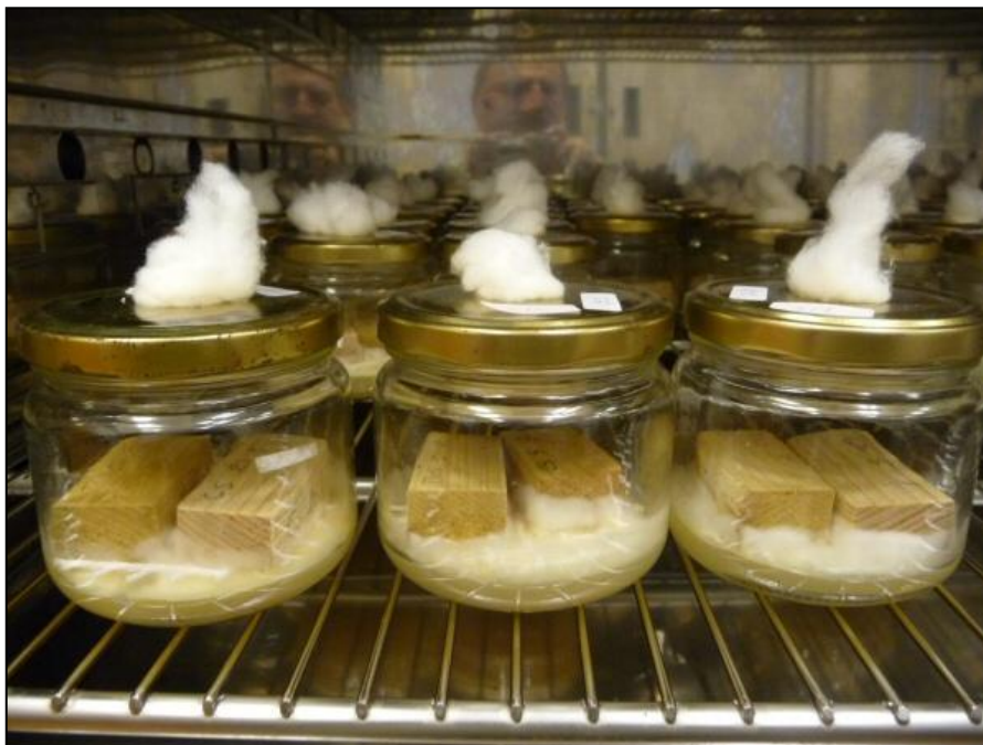
Slika 23: Začetna faza preraščanja micelija, levo tretirani, desno kontrolni vzorci, razlika v preraščanju je očitna (Foto: F. Pohleven)
