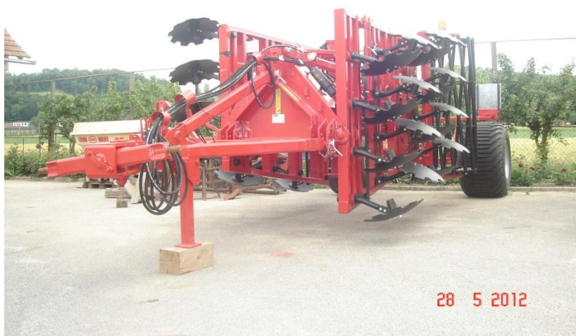
Slika 2: Specializiran priključek z diski za minimalno obdelavo tal (foto: Mihelič, 2012)
