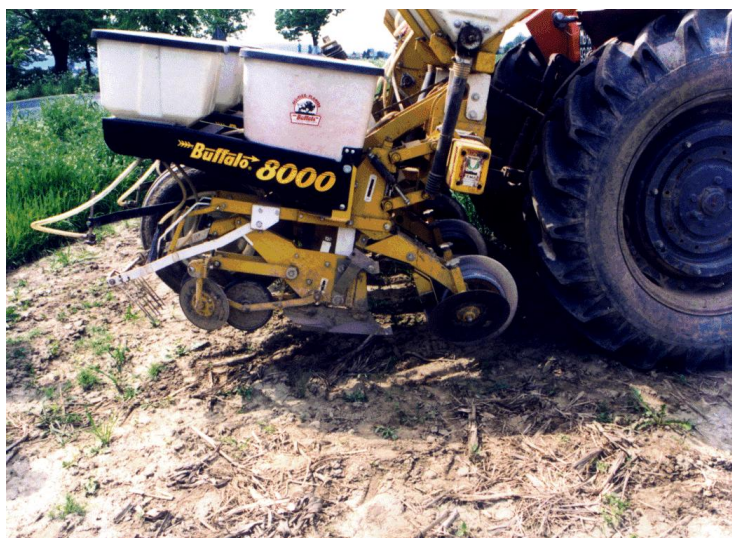
Slika 3: Specialna sejalnica za neposredno setev koruze (foto: Mihelič, 2012)
