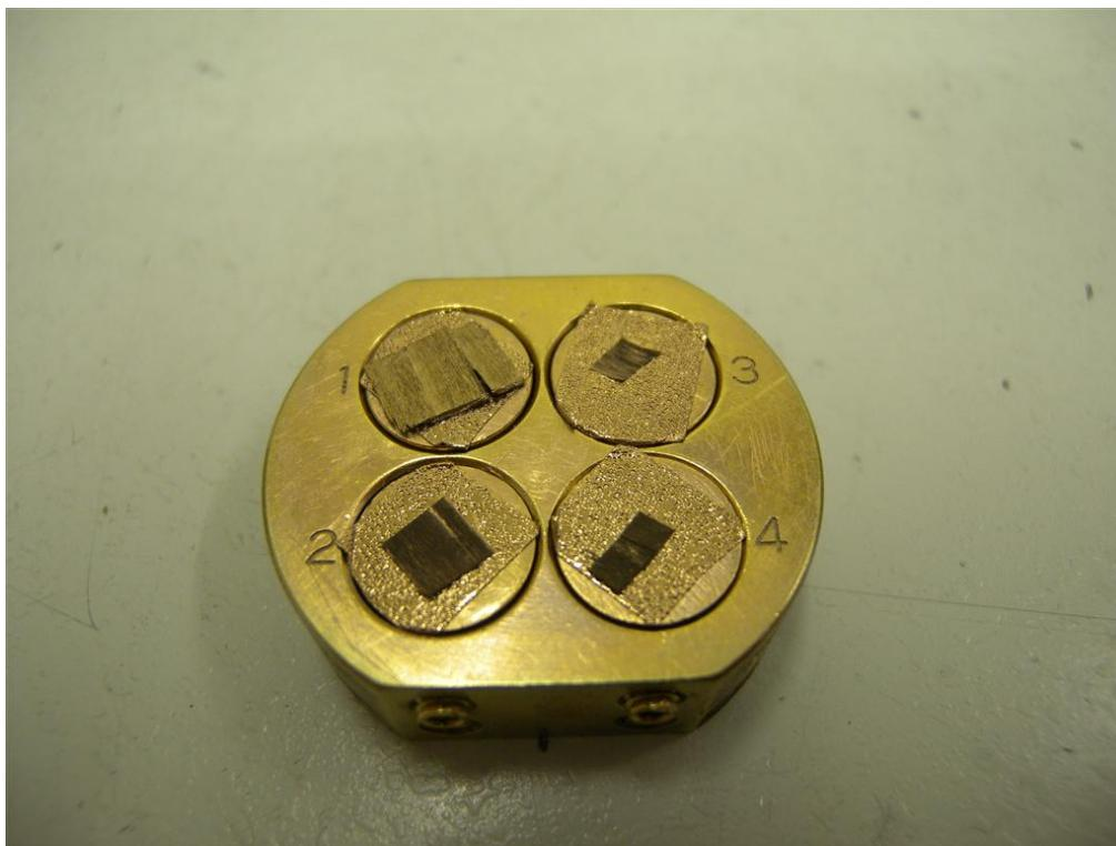
**Slika 4:** Priprava vzorcev za SEM analizo
