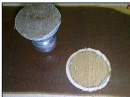
Slika 15: Adhezijski lom odtrganega pečata.
