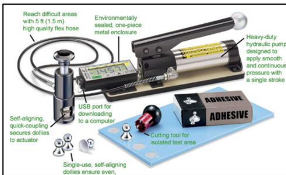
Slika 16: Predvidena oprema za izvajanje testov oprijemnosti z odtrganjem pečatov (Pavlič, 2010).
