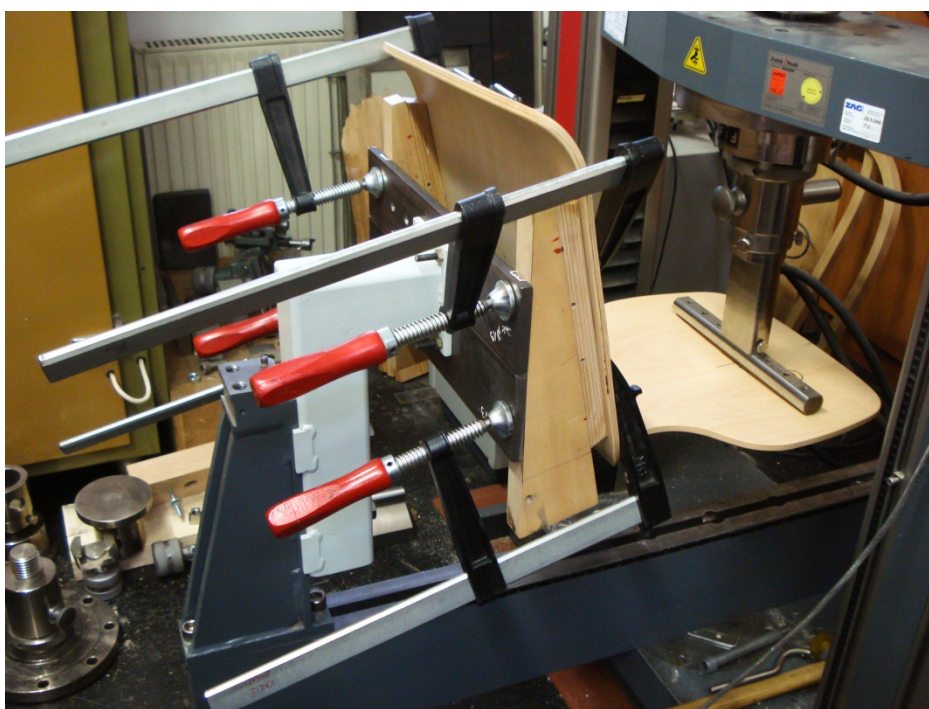
Slika 15: Vpenjanje lupine v testirni stroj Zwick
