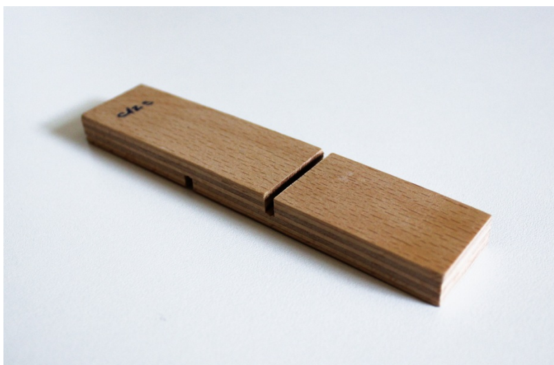
Slika 21: Vzorec za preizkus strižne trdnosti
