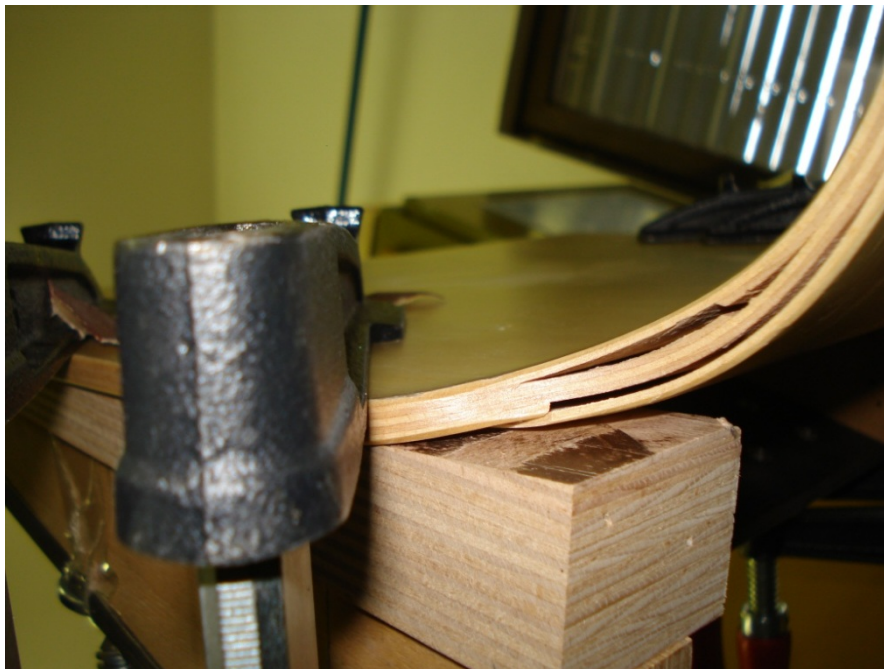
Slika 26: Porušitev lupine A
