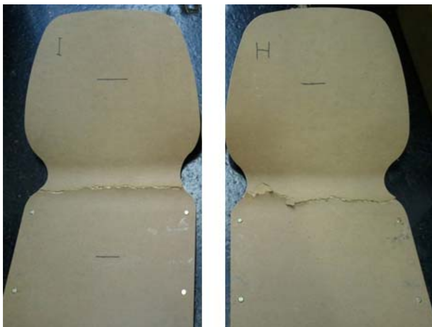
Slika 28: Porušitev lupin I in H
