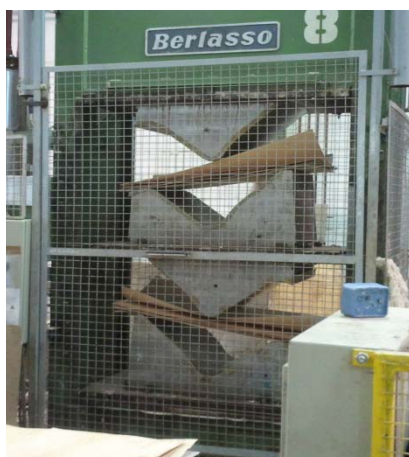
Slika 8: Stiskanje plošče v stiskalnici
