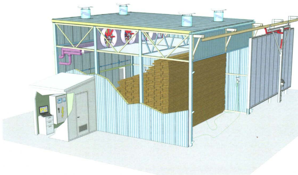
Slika 2 Skica komore za konvekcijsko sušenje (Incoplan, 2010)
