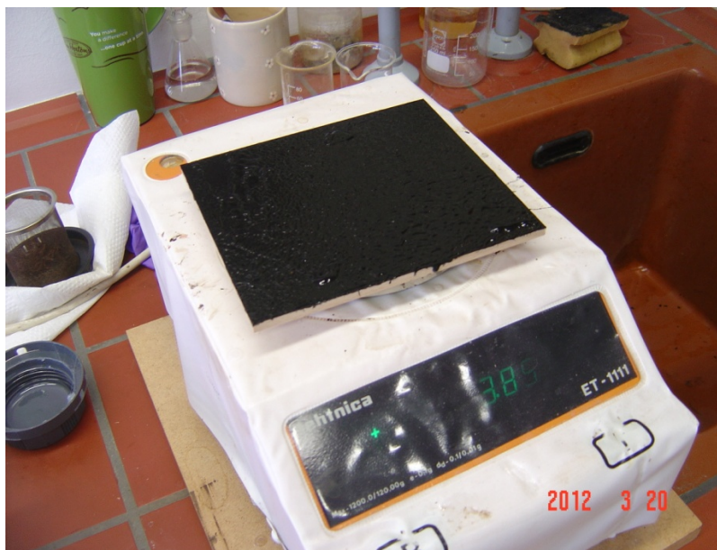
Slika 7: Lepilna mešanica, nanesena na bukovo lamelo
