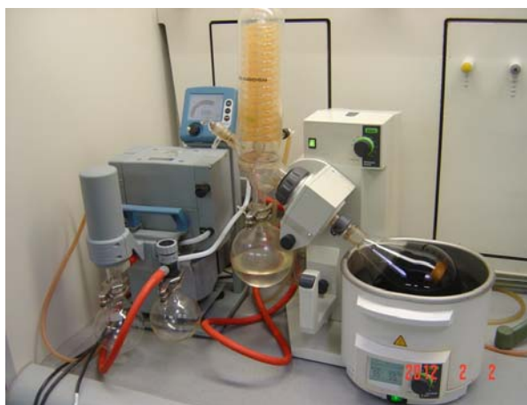
Slika 2: Odparevanje etilen glikola, 1-4 dioksana in vode
