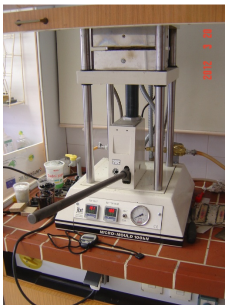
Slika 8: Stiskanje lepljencev iz dveh lamel z laboratorijsko stiskalnico
