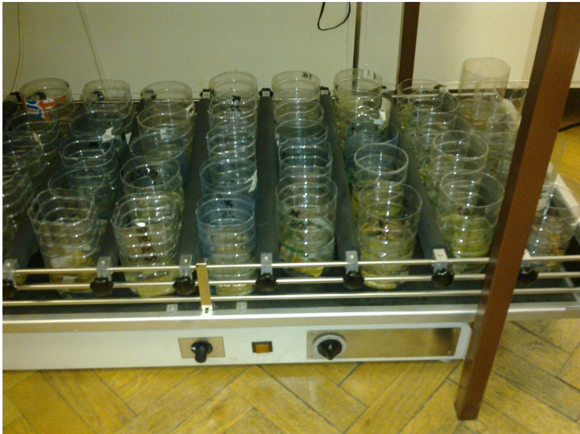
Slika 7: Izpiranje vzorcev na laboratorijskem stresalniku.
