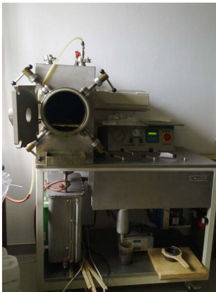
Slika 5: Vakuumsko – tlačna komora Kambič za impregnacijo.
