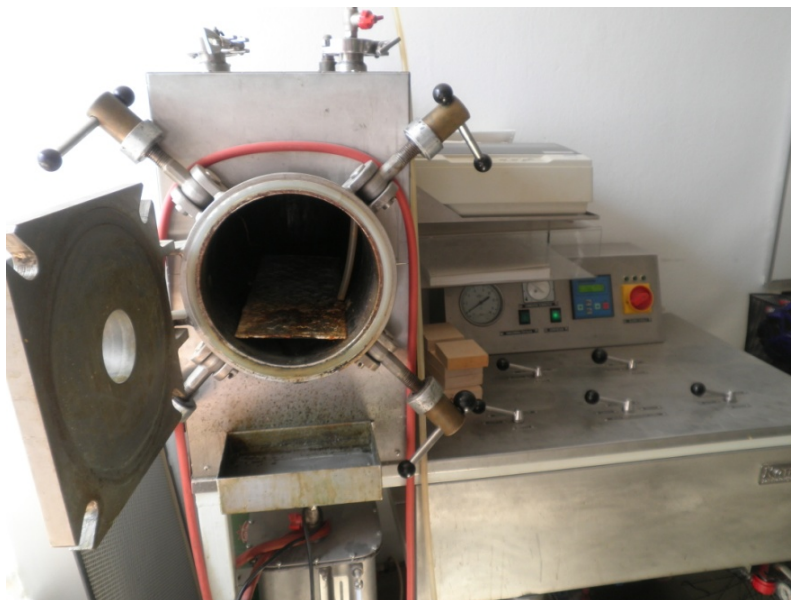
Slika 10: Tlačno-vakuumska komora Kambič.
