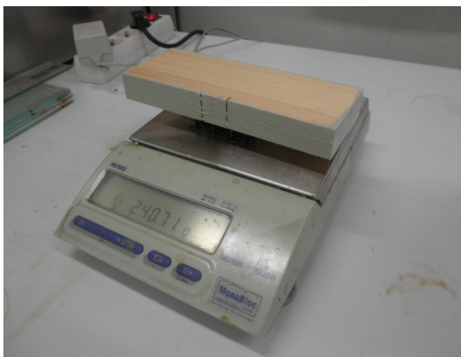
Slika 12: Tehtanje vzorcev med nanosom osnovnega premaza.
