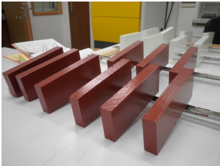
Slika 14: Vzorci po končnem nanosu sredstva proti obraščanju.
