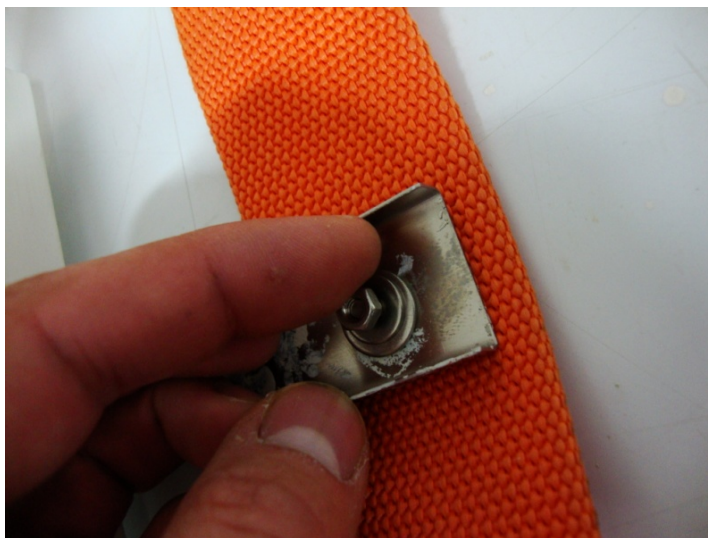
Slika 5: Pritrditev prečk iz nerjavečega jekla
