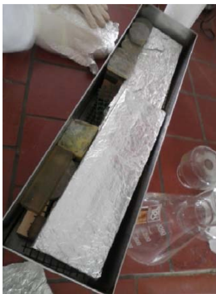
Slika 9: Obtežitev vzorcev v posodi pred zalitjem.
