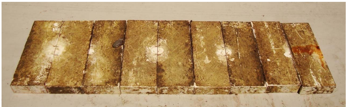
Slika 26: Trdi tip (C) premaza proti obraščanju z organizmi.
