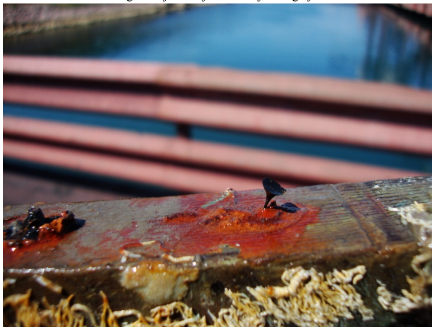
Slika 20: Stanje vijaka iz nerjavnega jekla po osmih mesecih v morju.
