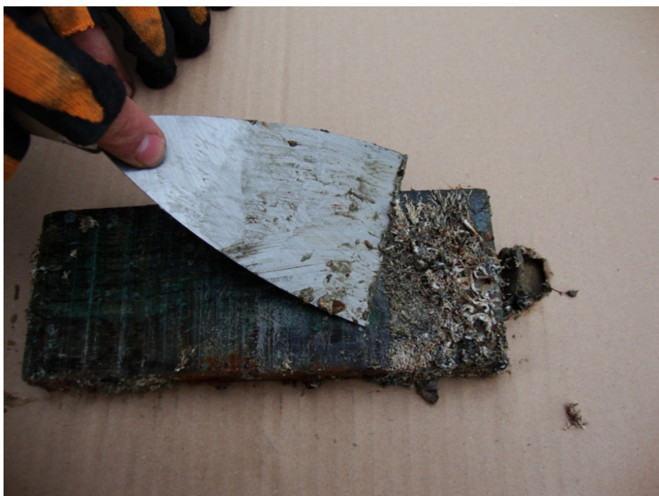
Slika 17: Čiščenje impregniranih z morskimi organizmi obraslih vzorcev.
