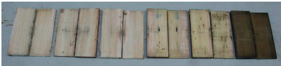
Slika 28: Vzorci, zaščiteni z premazi A, B, C, D, nezaščiteni in vzorci, impregnirani s Silvanolinom (od leve proti desni).
