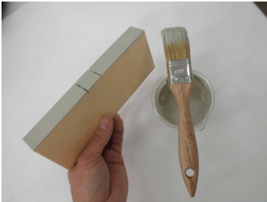
Slika 13: Nanos osnovnega premaza.
