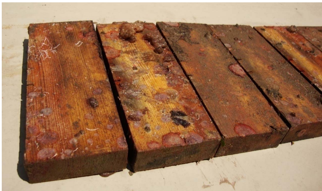
Slika 27: Neučinkovitost nano premaza (D) proti obraščanju.
