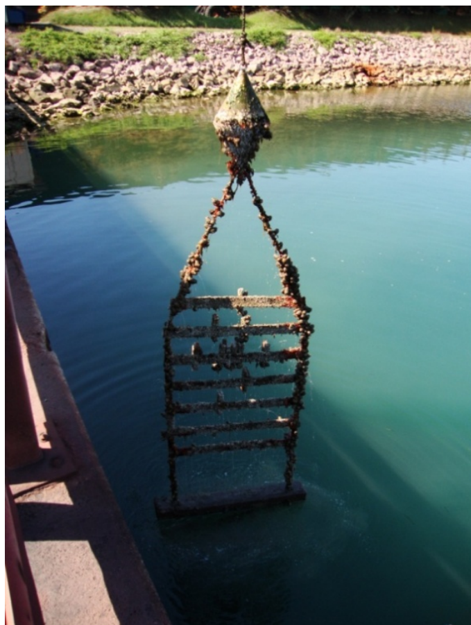
Slika 15: Izvlek vzorcev, kar jih je od skoraj 100-tih izpostavljenih ostalo še na prvem stojalu.
