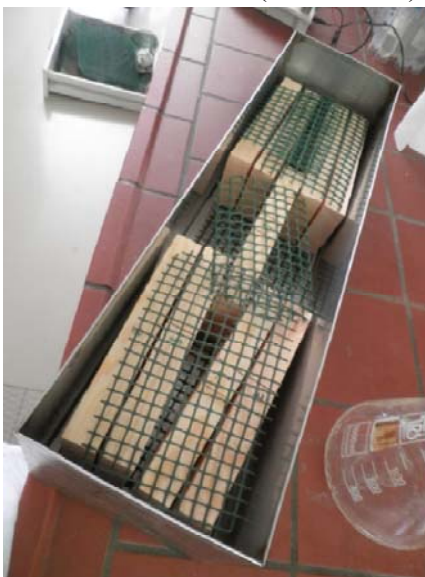
Slika 8: Razvrstitev lesenih vzorcev v posodi.
