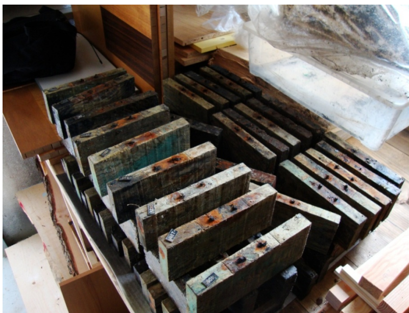
Slika 18: Delno sušenje vzorcev (teden dni pri sobnih pogojih).
