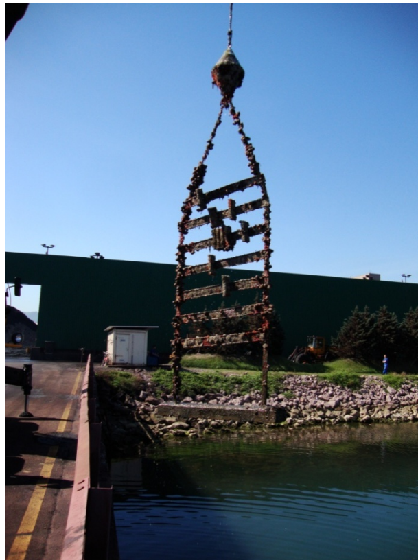
Slika 19: Ostanek vzorcev na stojalu, ki priča o agresivnosti našega morja na vijake iz nerjavečega jekla.
