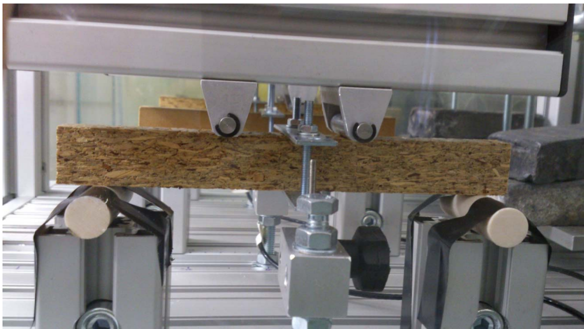
Slika 5: 4-točkovna obremenitev plošč
