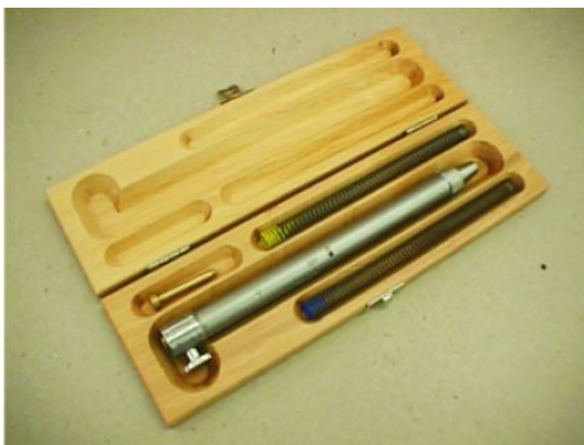
Slika 4: Vzmetni svinčnik za določanje trdote z razenjem (Pavlič, 2006)
