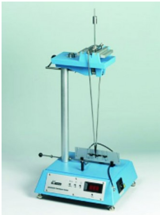
Slika 3: Naprava za določanje trdote z dušenjem nihanja Königovega nihala (Qualitest, 2011)
