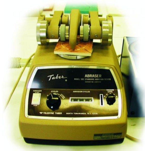
Slika 5: Taber-abraser za določanje odpornosti proti obrabi (Pavlič, 2006)
