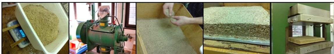
Slika 14: Prikaz postopka izdelave iverne plošče v laboratoriju
