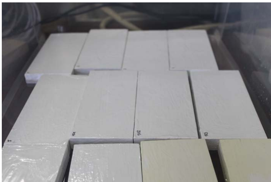
Slika 4: Vzorci potopljeni v posodi z vodo.
