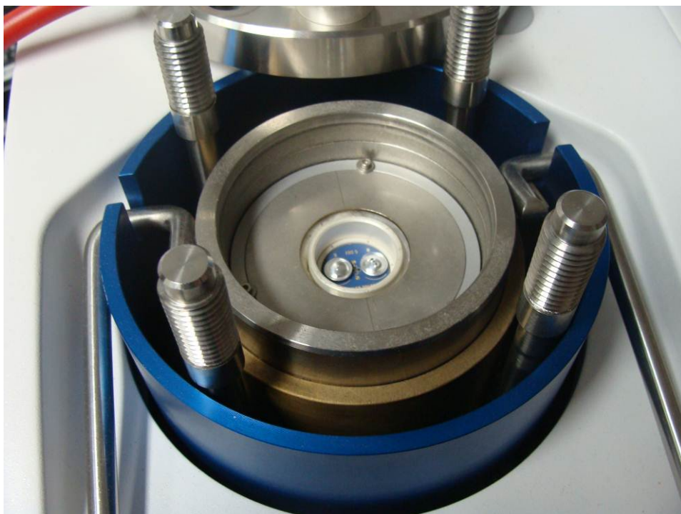
Slika 12: Vstavljanje vzorca v DSC (levo je lonček z vzorcem, desno pa je prazen lonček) .
