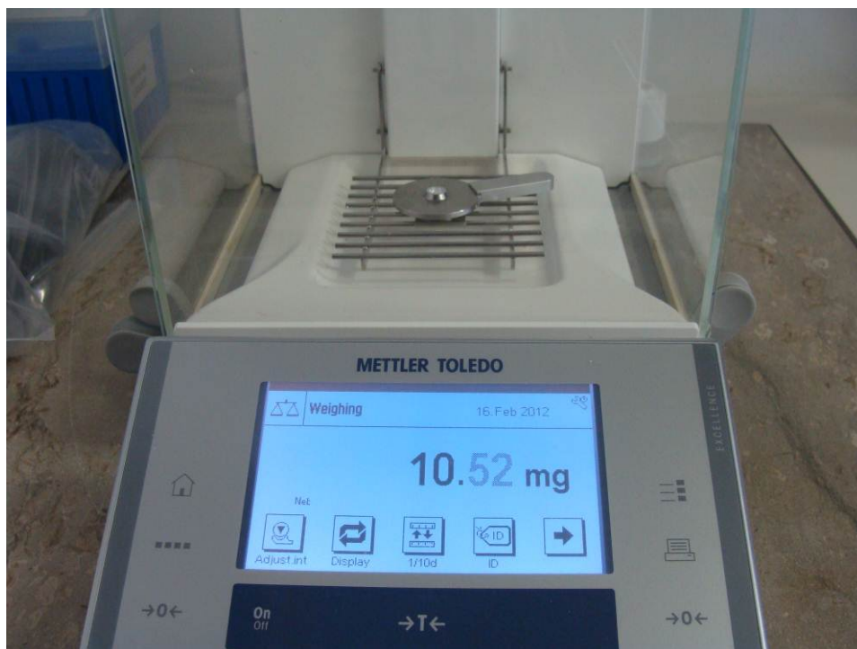
Slika 11: Tehtanje vzorca za DSC analizo. Masa lepilne mešanice je morala biti med 10,5 in 10,8 mg.
