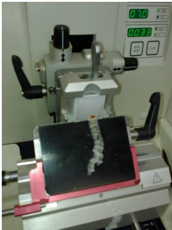
Slika 2: Rezanje rezin lesa z rotacijskim mikrotomom
