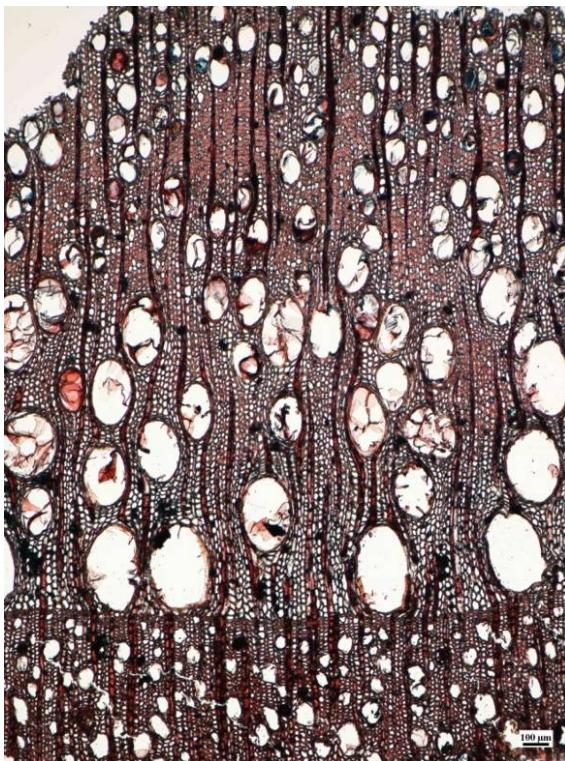
Slika 6: Mikroskopski pogled prečnega prerezja lesa ikone št. 15
