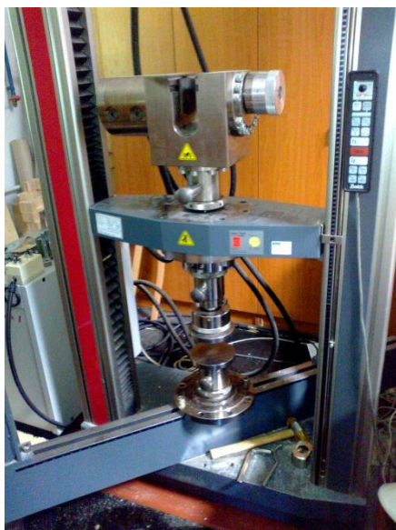
Slika 5: Vpenjalna glava stroja za testiranje ZWICK/Z100
