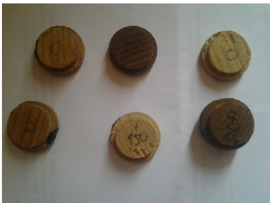
Slika 6: Smrekovi diski za reološke meritve med utrjevanjem lepila
