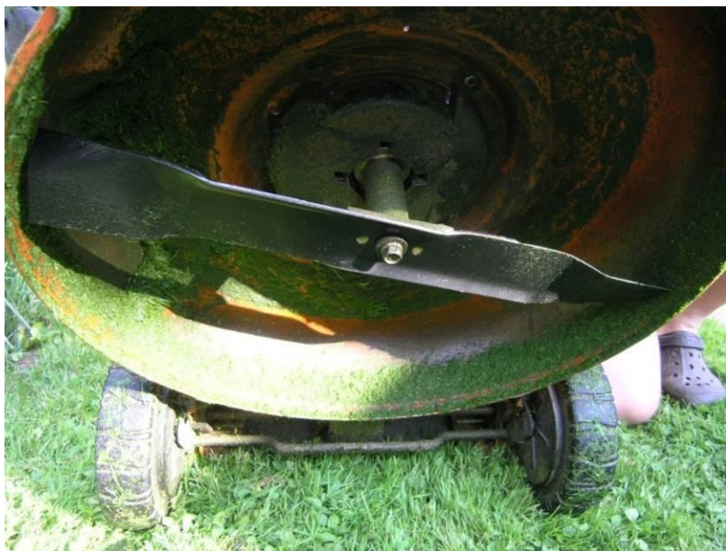
Slika 34: Ostanki trave v delovnem območju rezila B (osebni arhiv, 2012)
