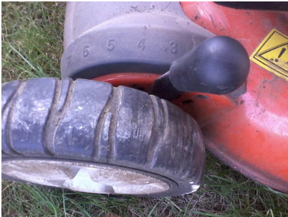
Slika 23: Nastavitev višine košnje spredaj (osebni arhiv, 2012)
