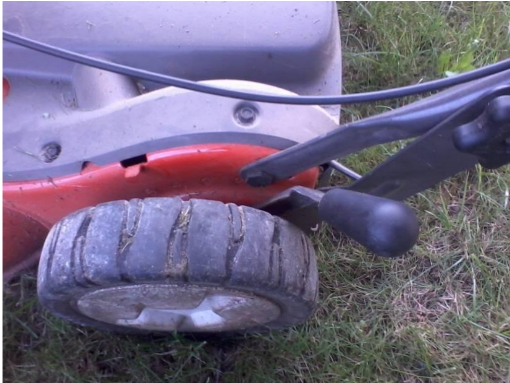
Slika 24: Nastavitev višine košnje zadaj (osebni arhiv, 2012)
