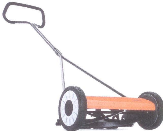
Slika 10: Ročno potiskana cilindrična kosilnica (osebni arhiv, 2010)
