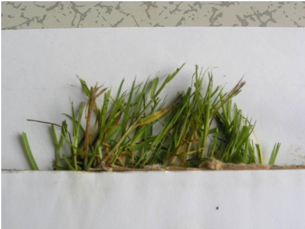
Slika 25: Popolnoma poškodovan travni rob pri rezilu A (osebni arhiv, 2012)
