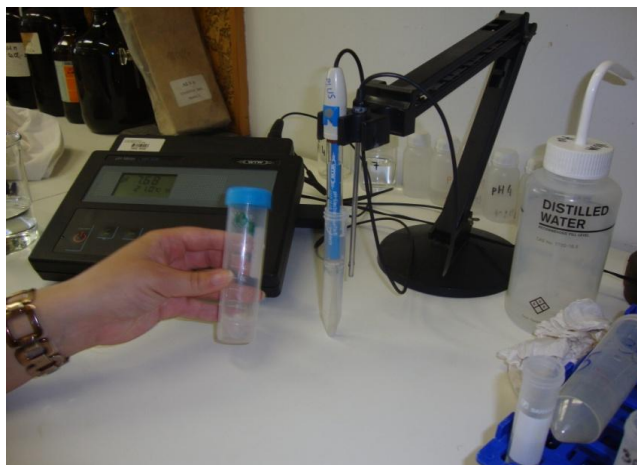
Slika 5: Meritev pH vzorcev (Laboratorij BF, 2010)
