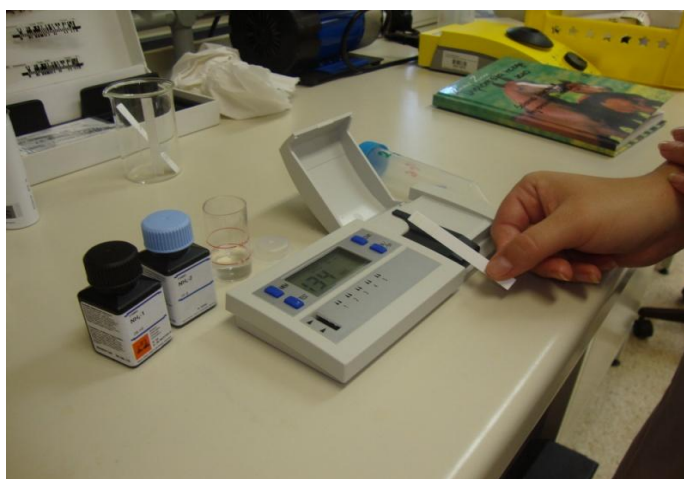
Slika 6: Meritev amoniaka z RQflex-om (Laboratorij BF, 2010)
