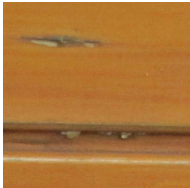
Slika 28: izstopanje smole pri A 1.4
