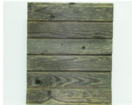
Slika 29: kontrolni vzorec D, po 18 mesečni izpostavitvi
