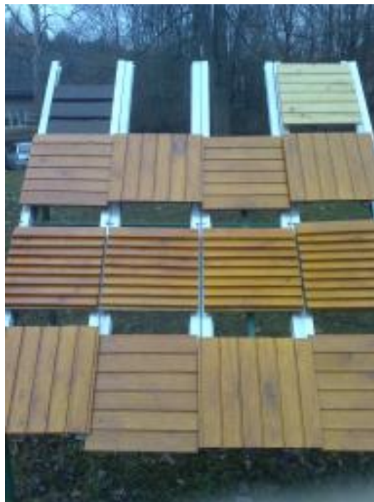
Slika 21: Konec opazovanja Vzorci po obdobju 16 mesecev. Površina je potemnela, kar je posledica vpliva zunanjih dejavnikov na les.
