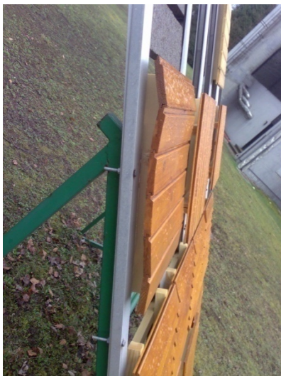
Slika 22: zvijanje pri vzorcih A 1.1
