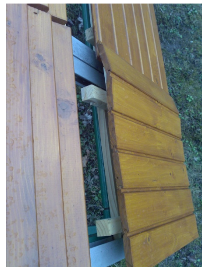
Slika 24: zvijanje na vzorcu B 1.3, ki je bil zaščitен po sestavi.
