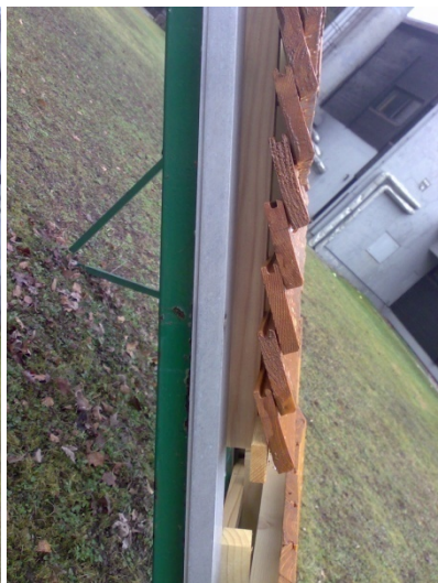
Slika 23: zvijanje na prekrivno pritrjenem vzorcu C 1.1
