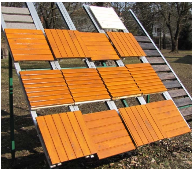
Slika 20: Konstrukcija na začetku opazovanja Vzorci smo izpostavili vremenskim razmeram na stojalu pod kotom 45°. Prikazani so vsi testirani vzorci.
