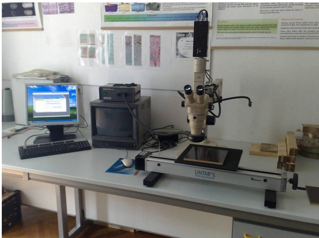
Slika 6: Merilne naprave desno (mikroskop, mizica, kamera) in računalnik desno.
