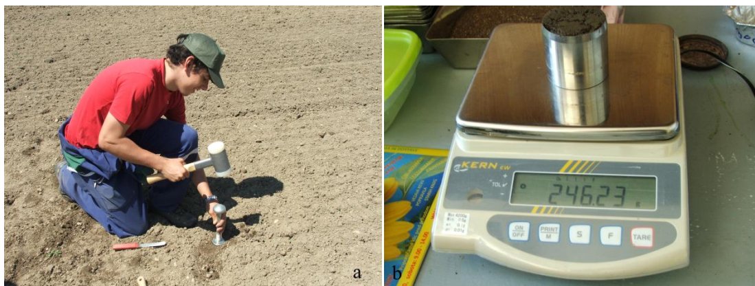
Slika 16: Odvzem vzorca tal s Kopeckijevim cilindrom (a), sušenje vzorca (b) (foto: Damjan Jakofčič, 2012)
