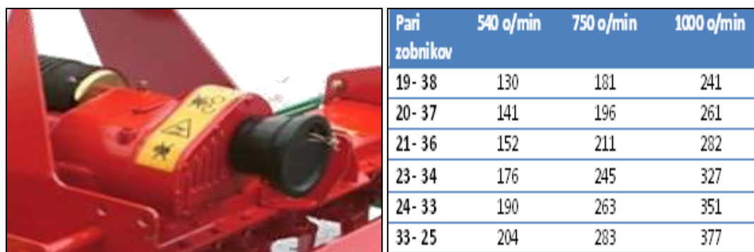
Slika 7: Zobniški menjalnik in vrtilna frekvenca nožev Kverneland NG-H 101 (Kverneland ..., 2010)
