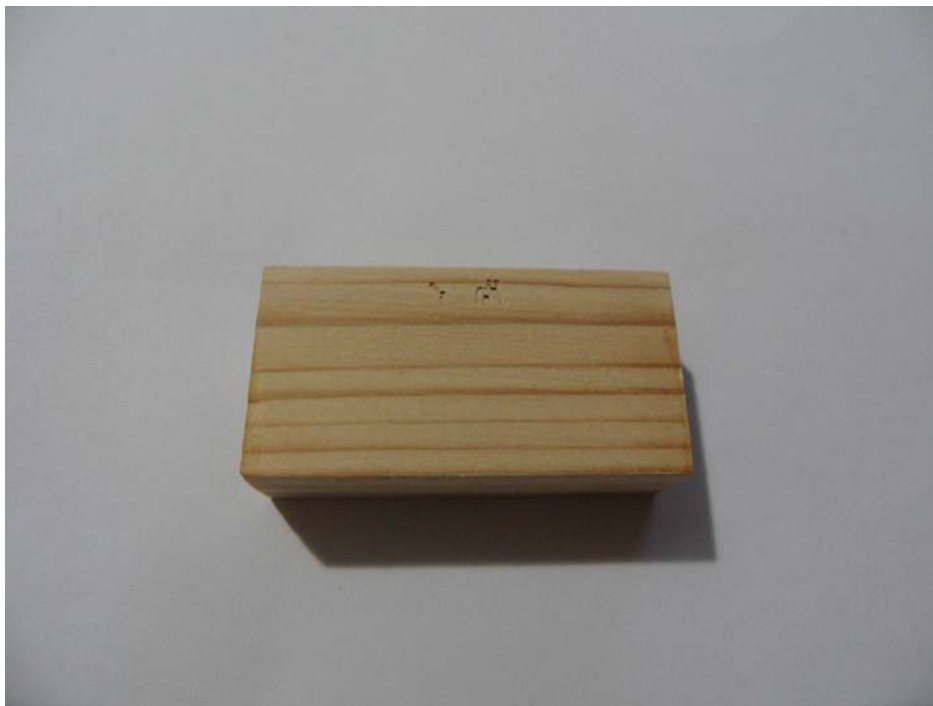
Slika 19: Poškodba kontrolnega vzorca bora po 12 tednih na površini (foto: B. Mikuš)
