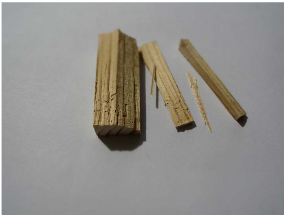
Slika 190: Poškodba kontrolnega vzorca bora po 12 tednih v notranjosti (foto: B. Mikuš)
