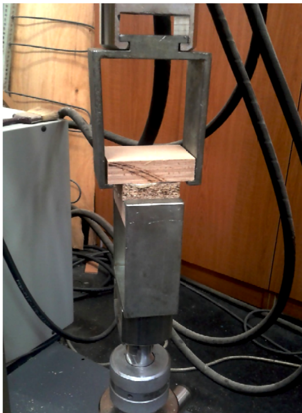
Slika 6: Vpenjalne čeljusti s testnim kosom za razslojno trdnost
