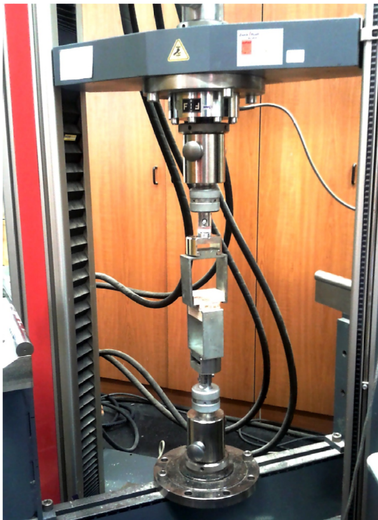
Slika 7: Preizkus razslojne trdnosti na stroju za testiranje oz. preizkušanje lesa in lesnih kompozitov ZWICK Z100
