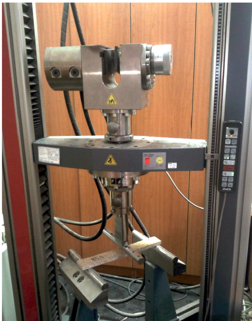
Slika 5: Preizkus upogibne trdnosti na stroju za testiranje oz. preizkušanje lesa in lesnih kompozitov ZWICK Z100
