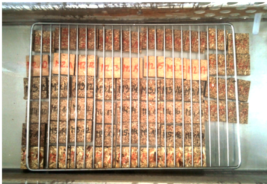
Slika 4: Potapljanje vzorcev v vodni kopeli
