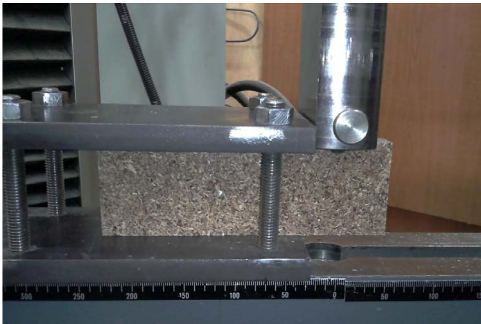
Slika 8: Vpenjalna glava za preizkus strižne trdnosti
