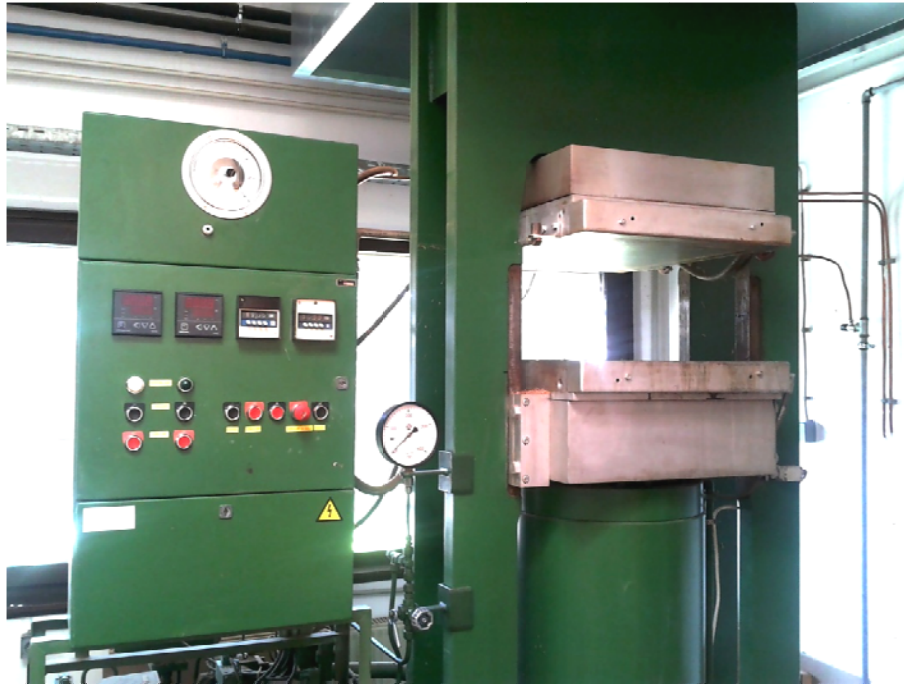
Slika 2: Hidravlična laboratorijska stiskalnica za iverne plošče LT63
