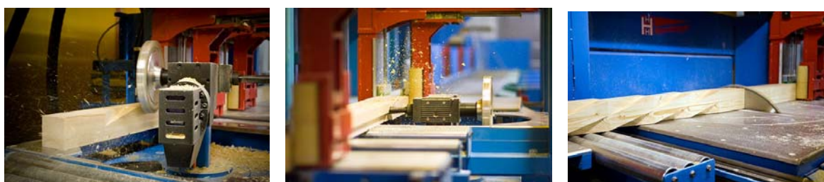
Slika 69: Obdelava lesa na računalniško vodeni liniji Hundegger-K2i (arhiv podjetja Honkatalog, 2007)
