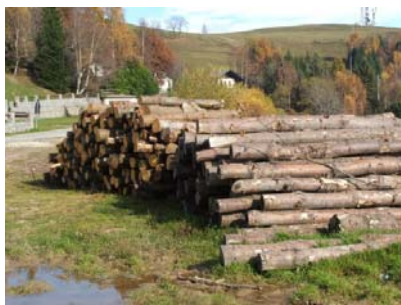
Slika 65: Nepravilno skladiščenje hlodovine (foto: Andraž Nagode)
