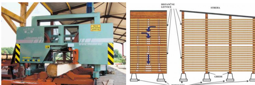
Slika 66: Žaga za razrez hlodovine (Pucelj, 2010) in pravilno sušenje žaganega lesa (Gorišek, 2004)
