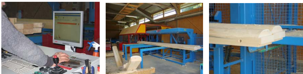
Slika 68: Računalniško vodena linija Hundegger-K2i z natančnostjo obdelave do desetinke milimetra natančno (foto: Andraž Nagode)
