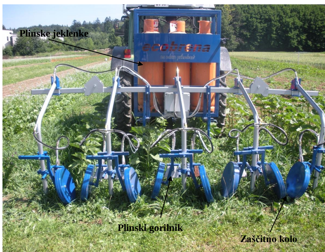
Slika 10: Ožigalnik ecobrena med delom (Foto: Šetinc, 2009)
