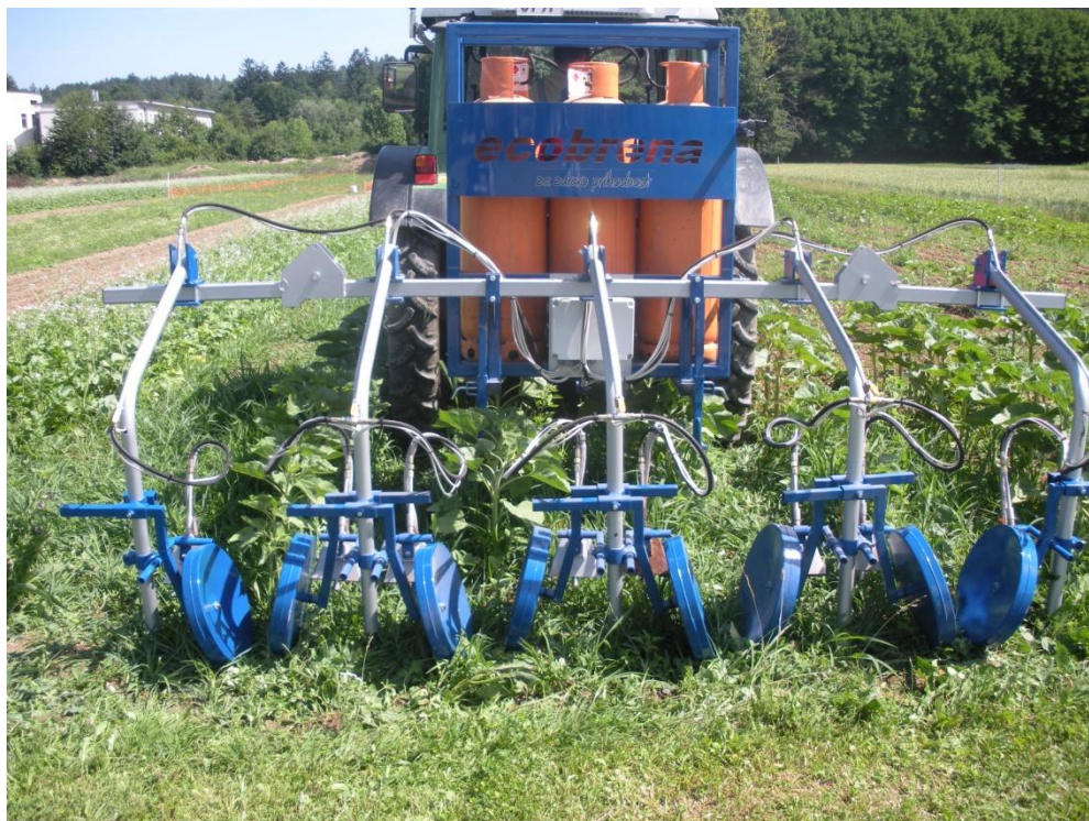
Slika 16: Ožiganje plevela z plinskim gorilnikom ECOBRENA (Foto: Šetinc, 2009)
