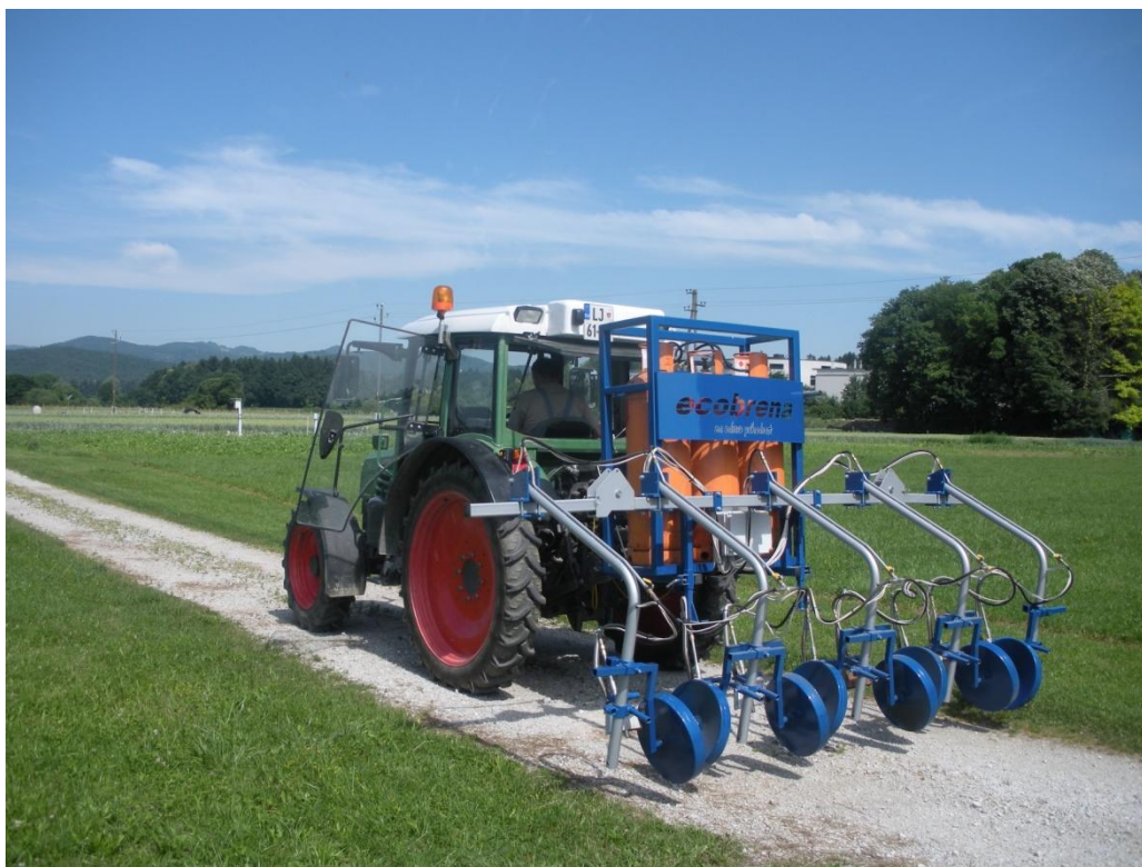
Slika 9: Naprava za termično uničevanje plevela ECOBRENA (Foto: Šetinc, 2009)
