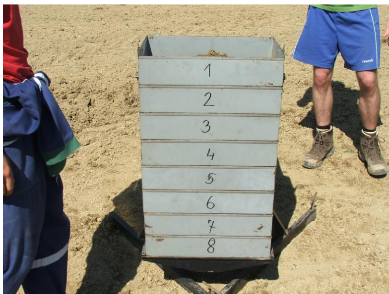
Slika 13: Naprava s sedmimi različnimi siti za ugotavljanje velikosti talnih delcev
