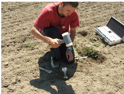
Slika 12: Odvzem vzorca s Kopeckym cilindrom
