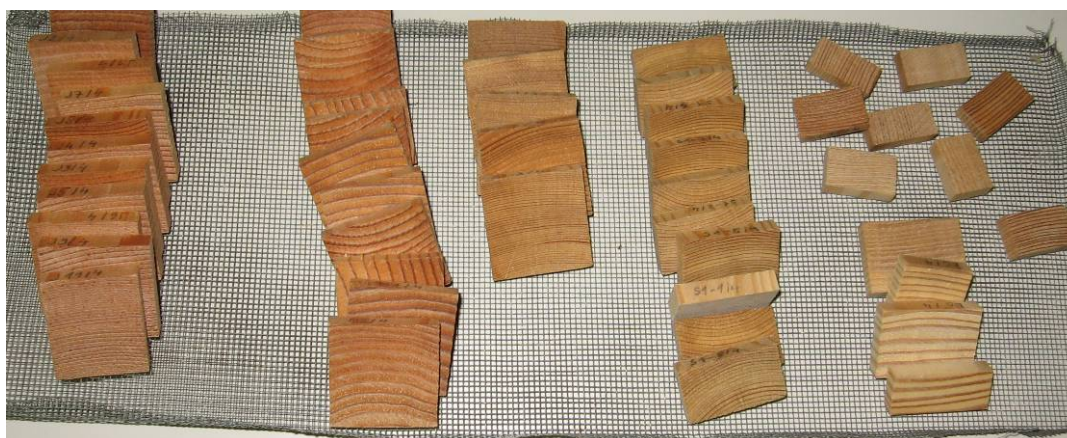
Slika 4: Vzorci za merjenje deležev ranega in kasnega lesa in štetje smolnih kanalov
