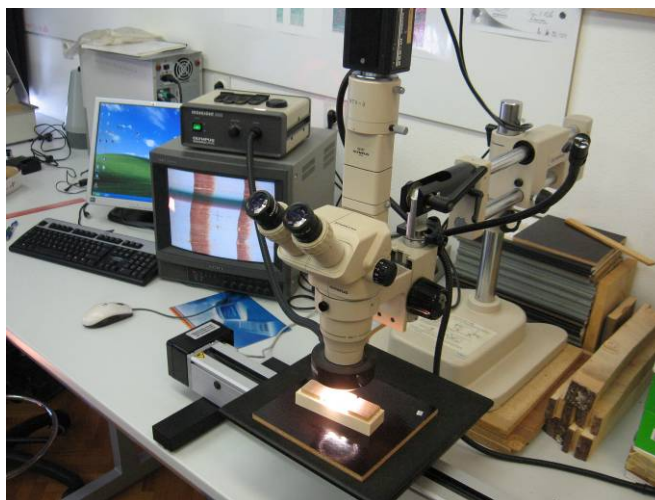
Slika 6: Merilna mizica Lintab s stereo lupo Olympus SZ – STU2
