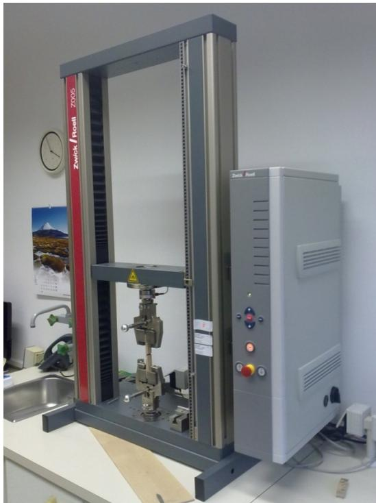
Slika 9: Univerzalni testirni stroj Zwick
