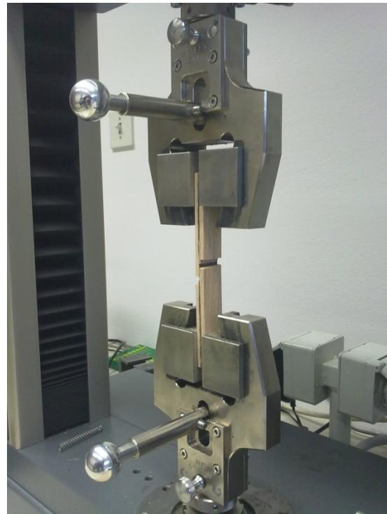
Slika 10: Čeljusti testirnega stroja
