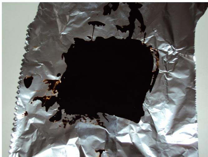
Slika 16 Barva utekočinjenega lesa po filtraciji (neutrjen)
