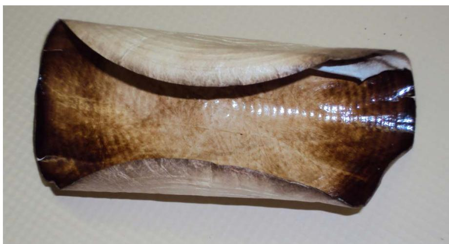
Slika 12 Filtrirni papirček po ultrafiltraciji, posušen v tesno zaprti vrečki
