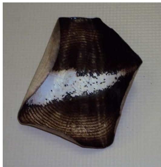
Slika 11 Filtrirni papirček po ultrafiltraciji, posušen na zraku
