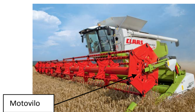
Slika 11: Pravilno nameščeno motovilo med žetvijo (LEXION: Die total andere klasse, 1999)
