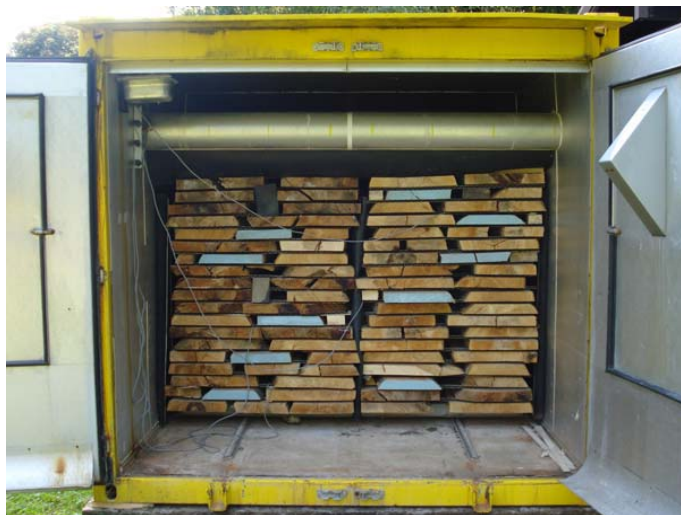
Slika 5: Natančna priprava in pravilno polnjenje komore je omogočilo optimalno izkoriščanje zračnega toka za sušenje. Žaganice z obarvanimi čeli smo uporabili za sukcesivno spremljanje sušilnega procesa.
