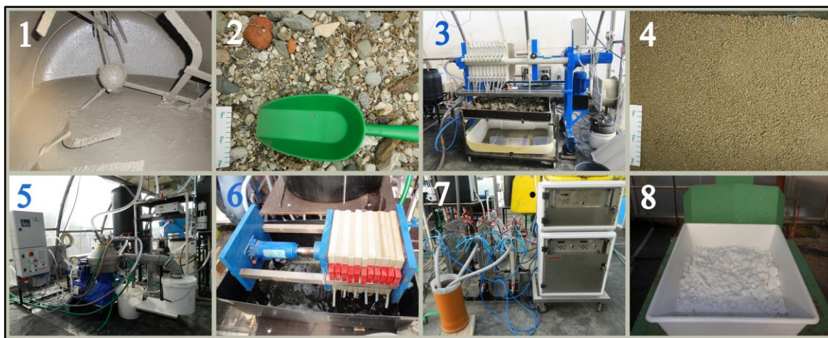
Slika 2: Pilotna shema pranja tal. Korak 1: pranje tal. Korak 2: separacija in spiranje skeleta, peska. Korak 3: spiranje tal in separacija tal ter pralne raztopine v komorni preši. Korak 4: drobljenje tal v enakomerne agregate. Korak 5: alkalna substitucija in oboritev PSK. Korak 6: recikliranje EDTA. Korak 7: elektrolitska degradacija EDTA, ki je preostala v pralni raztopini. Korak 8: Priprava reciklirane pralne raztopine (Voglar in Leštan, 2014).
