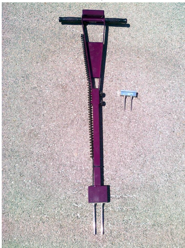
Slika 14: Merilnik vlage tal, FieldScout TDR 300
