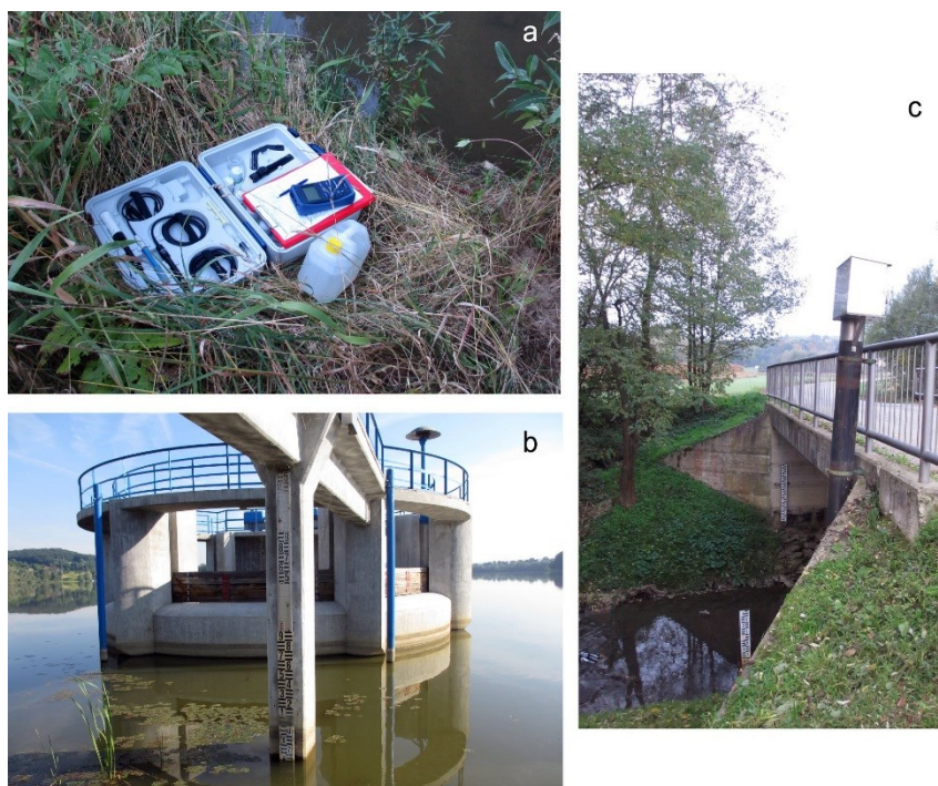
Slika 21: Merilno mesto za kakovost na reki Ledavi z multiparametersko sondo WTW Multi 340i (a), vodomerna lata ob izlivnem objektu na Ledavskem jezeru (b) in vodomerna postaja v Nuskovi na reki Ledavi (c)
