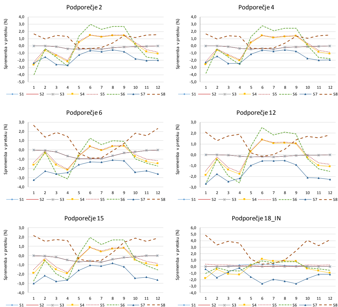
Slika 39: Spremembe v povprečni mesečni vrednosti pretoka po izbranih podpovodjih (2, 4, 6, 12, 15 in dotok v podpovodje 18) med osnovnim in testnimi scenariji vodozbirnega območja Ledavskega jezera Figure 39: Changes in average monthly flow values at selected subbasins (2, 4, 6, 12, 15 and inflow to subbasin 18) between the base and test scenarios of the Ledavsko jezero watershed
