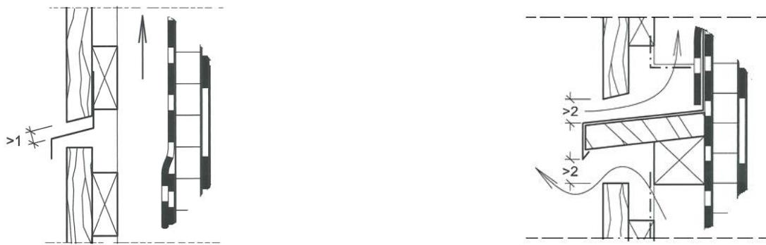
Slika 15: V prvem primeru (levo) je zatekanje vode v režo fasadne členitve preprečeno s kovinsko obrobo, ki je pritrjena na prečno letev za opažem. V drugem primeru (desno) zatekanje vode preprečuje polica s kovinsko obrobo nameščeno za vertikalno izolacijo stene. V obeh primerih je obroba v naklonu, odkapni rob sega čez linijo opaža, čelne površine in hrbtni deli opaža pa so zračeni (Brandstätter in sod., 2007)
