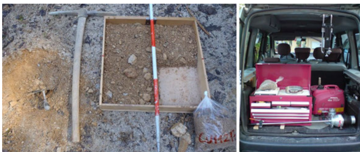
Slika 28: Terenska oprema za odvzem in obdelavo gravimetričnega vzorca iz obrabnega sloja ceste
