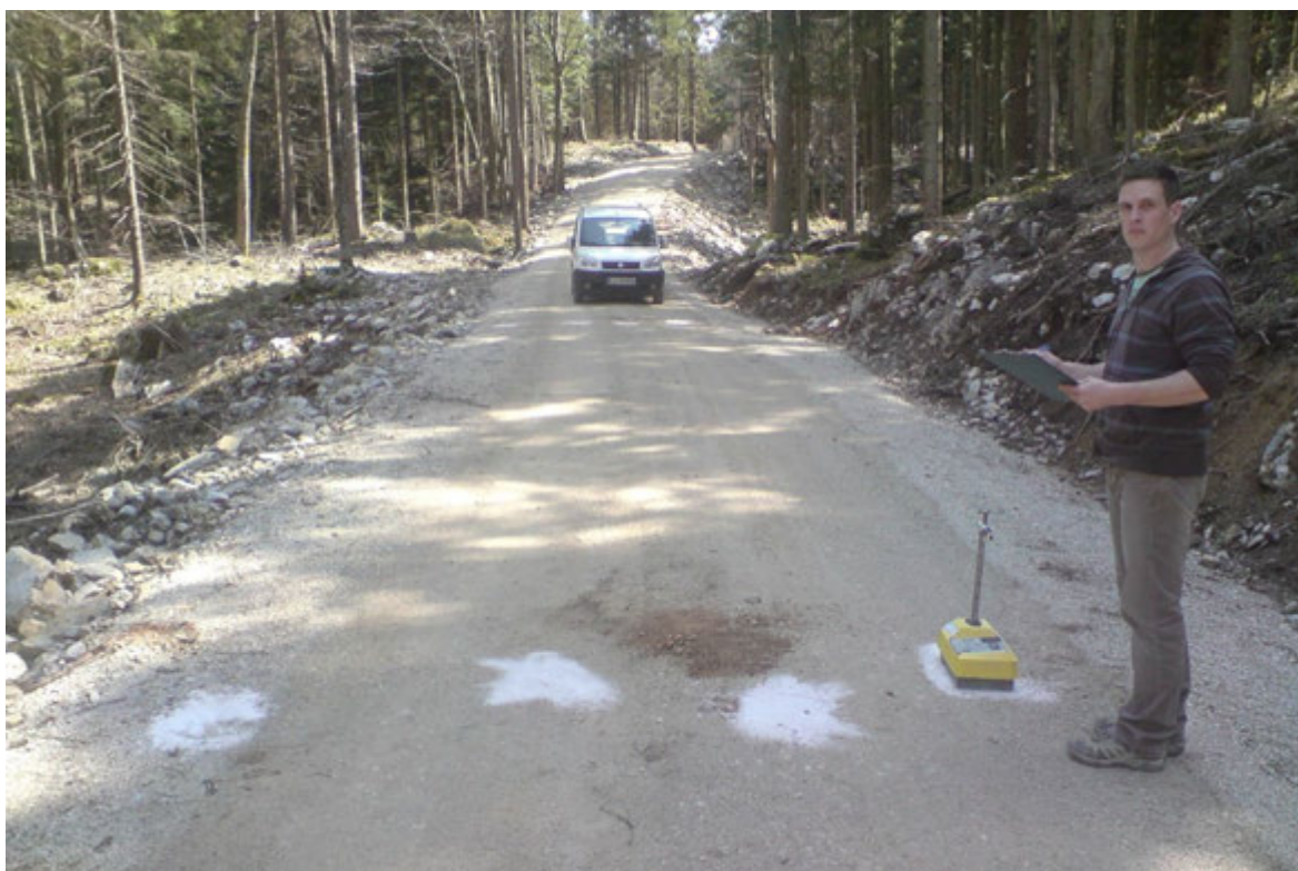
Slika 29: Meritve vlažnosti z izotopsko sondo na cesti »Čutarovka«
