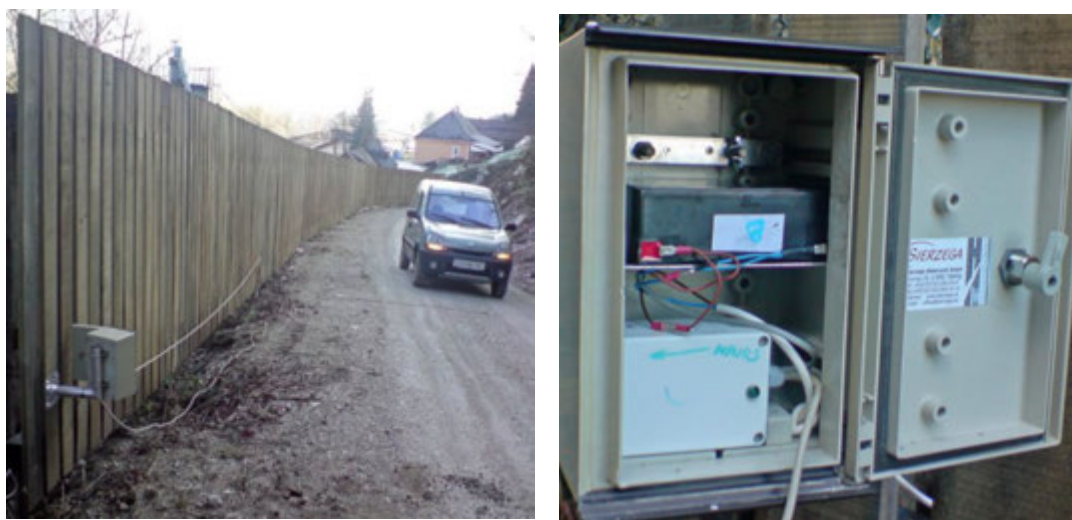
Slika 26: Montaža števca prometa na cesti »Soteska« (levo) in komponente naprave (desno)
