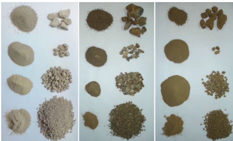
Slika 65: Zrnavost materialov voziščne konstrukcije enega izkopa gozdne ceste na mešani podlagi (levo: globina 0–10 cm; sredina: globina 10–30 cm; desno: globina 30–40 cm)
