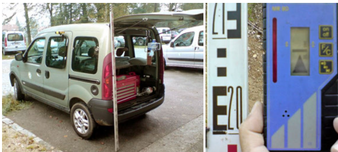
Slika 33: Oprema za meritve oblike cestišča (levo) in postopek merjenja višin (desno)
