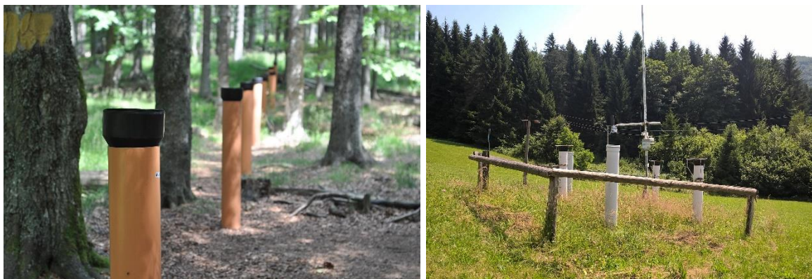
Sl. 4: Prikaz vzorčevalnikov za usedline na ploskvah IMGE znotraj sestoja (leva slika) in na odprtem (desna slika)
