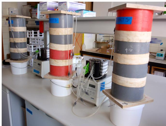
Slika 4: Priprava kontrolnih in stabiliziranih tal v kolonah; faza vlaženja tal do 100 % poljske kapacitete.
