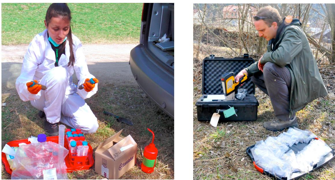
Slika 5: Določanje pH vrednosti (levo) in vsebnosti PSK s XRF metodo (desno) v talnih vzorcih na terenu
