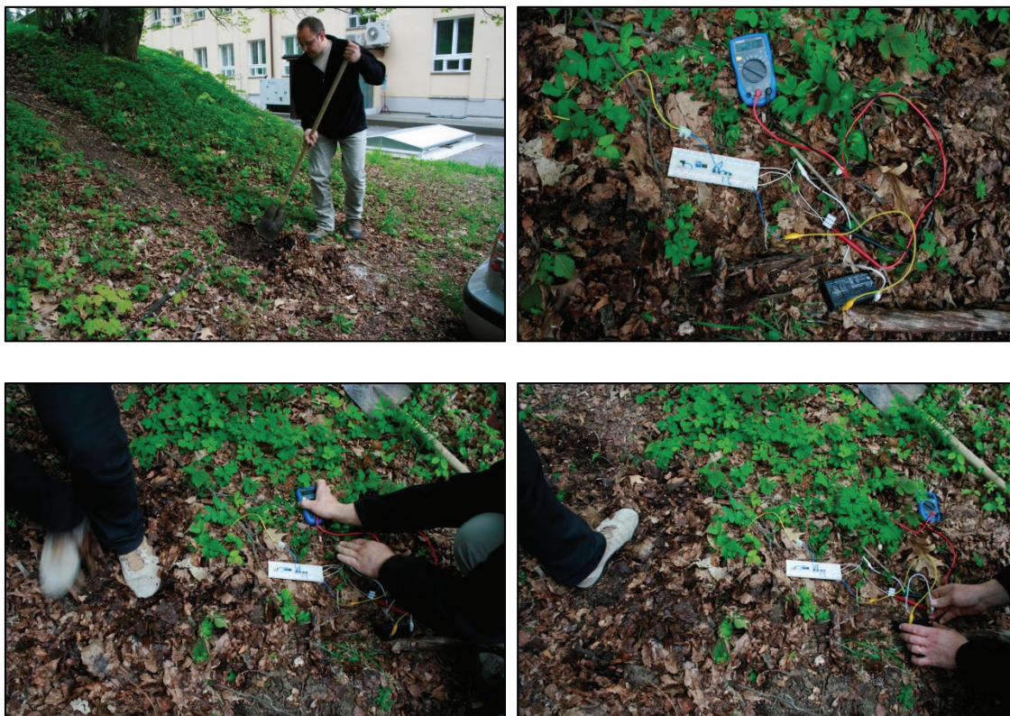
Slika 23. Namestitev piezo senzorja za testne meritve Picture 23. Instalation of a piezo sensor for pilot measurements
