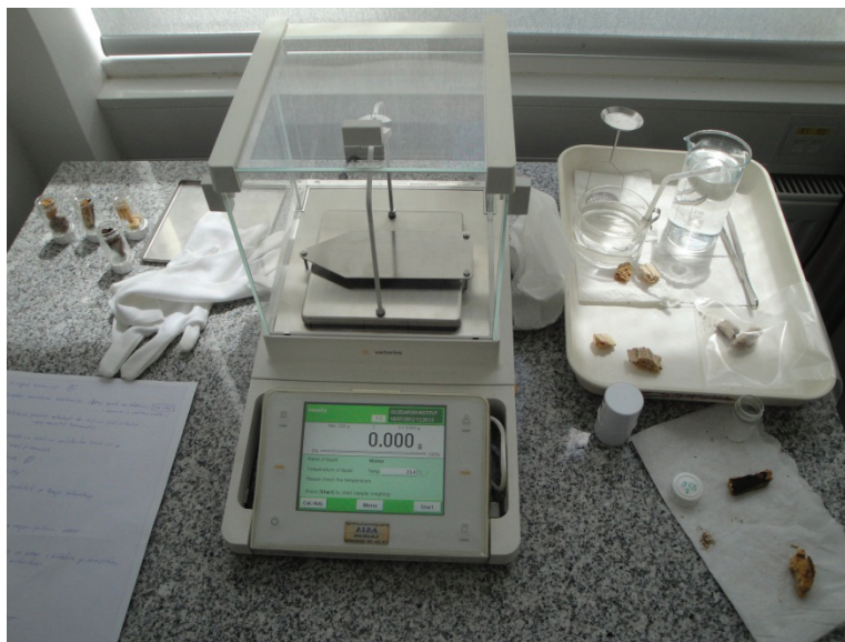
Slika 6: Tehnica Sartorius MSA 323S z dodatkom za merjenje gostot YDK01 (foto: Domen Finžgar, 2012)
