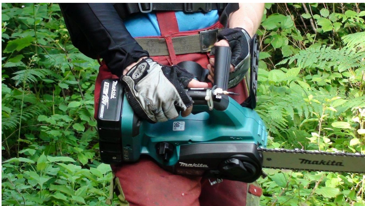
Slika 1: Položaj pospeškomera na vodilnem ročaju akumulatorske motorne žage Makita DUC302Z
