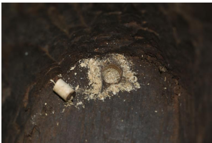
Slika 6: Primer odvzema vzorca v obliki izvrtka premera 7 mm
