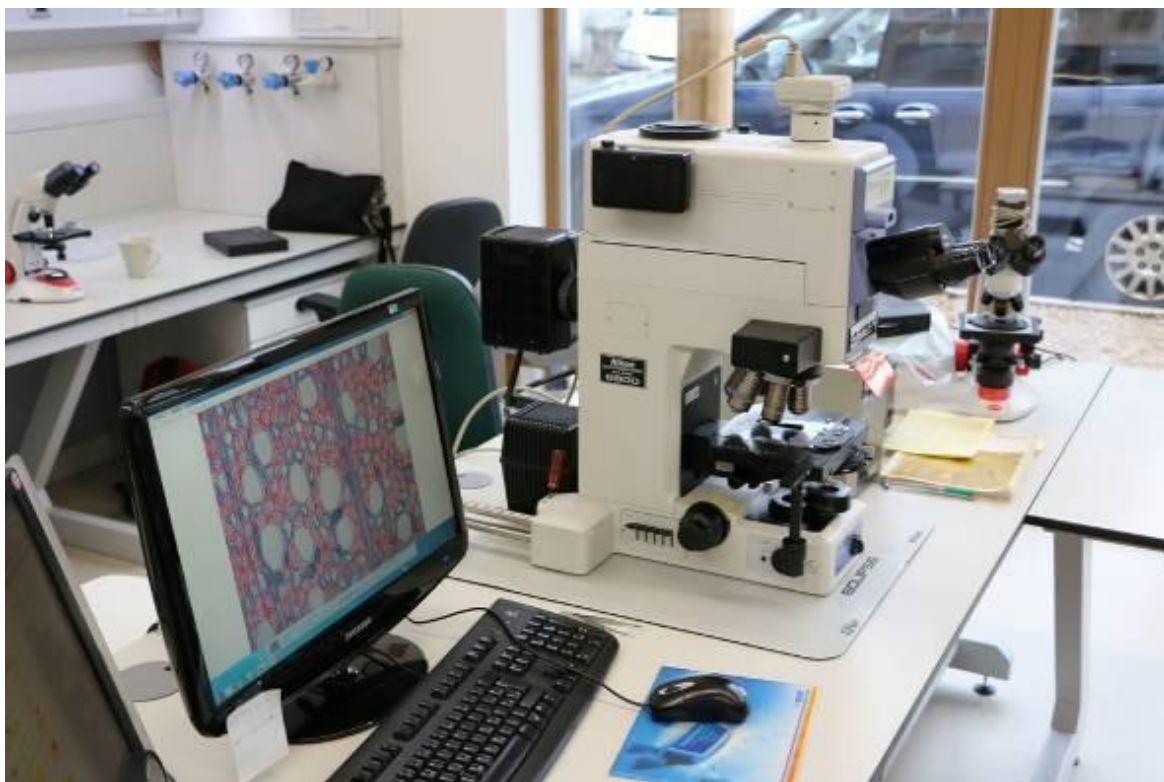
Slika 10: Mikroskop Nikon Eclipse 800 in računalnik, na katerem smo opravili pregled ter fotografiranje anatomskih preparatov lesa (Foto: Kemperl, 2016)
