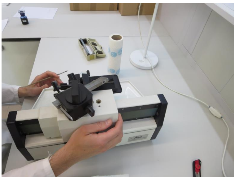
Slika 7: Rezanje tankih rezin lesa na drsnem mikrotomu Leica
