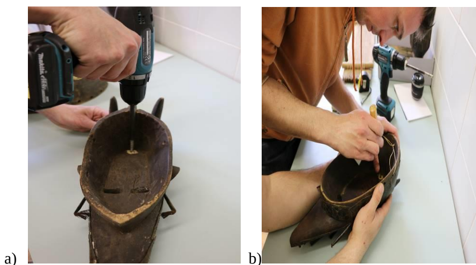
Slika 5: Orodje za odvzem vzorcev; a) vrtanje s prirejenim votlim svedrom in b) uporaba dleta
