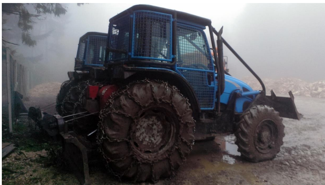
Slika 4: Ustrezno opremljen kmetijski traktor za delo v gozdu, z gozdarsko nadgradnjo, znamka Landini. Lastnik traktorja je član DLG pod Gorjanci. (Foto: P. Žlogar)
