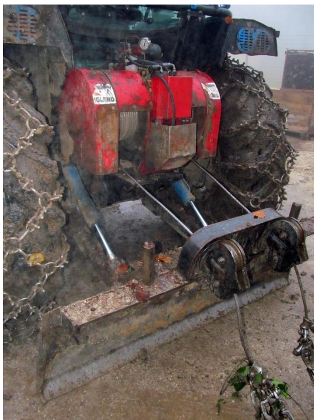
Slika 7: Vitel Igland z zaščito in daljinskim vodenjem, last lastnika gozda iz DLG pod Gorjanci (Foto: P. Žlogar)
