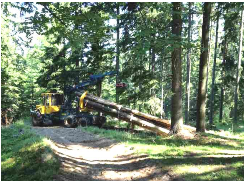
Slika 18: Spravilo dolgih sortimentov s pomočjo sedlastih klešč
