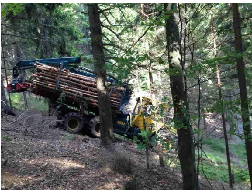
Slika 15: Spravilo kratkih sortimentov s strojem HSM 805F (foto: Matevž Mihelič)
