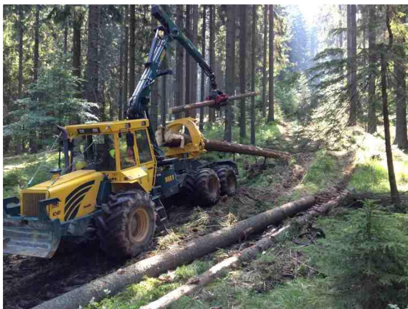
Slika 12: Nalaganje dolgih sortimentov v sedlaste klešče (foto: Matevž Mihelič)
