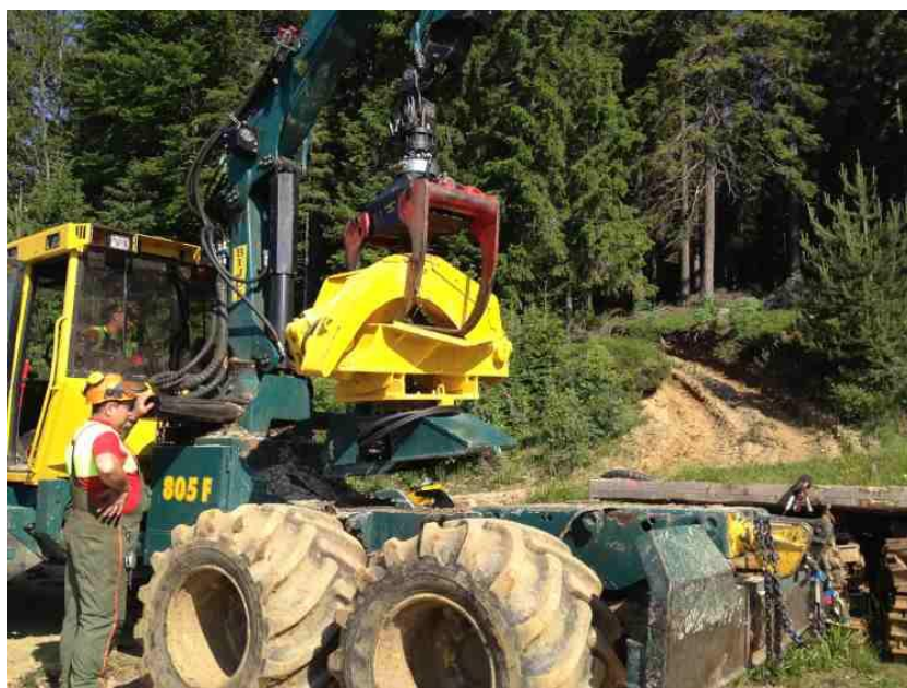
Slika 6: Montaža sedlastih klešč na stroj HSM 805F za spravilo dolgih sortimentov (foto: Matevž Mihelič)
