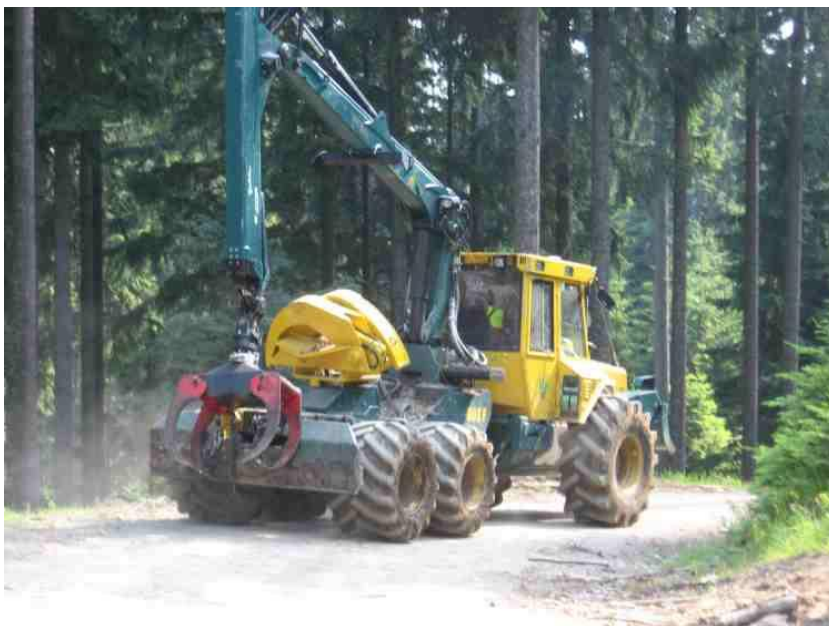
Slika 11: Stroj HSM 805F z nameščenimi sedlastimi kleščami za spravilo dolgih sortimentov (foto: Saša Kencijan)
