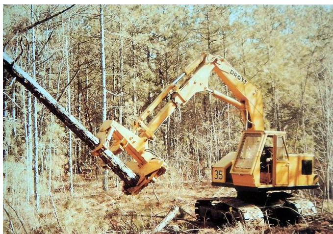
Slika 5: Drott Feller Buncher (stroj za podiranje) z za takrat revolucionarno tehniko podiranja (Drushka in Kontinen, 1997)
