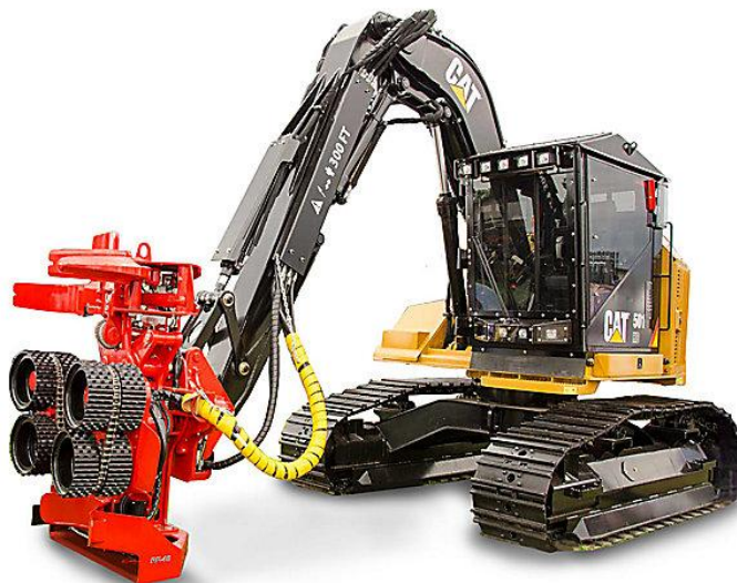
Slika 21: Primer univerzalnega stroja za sečnjo - CAT 501HD (Cat, 2016)
