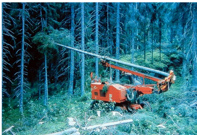
Slika 9: Pika 75 iz leta 1972, kot eden prvih finskih harvesterjev (Drushka in Kontinen, 1997)
