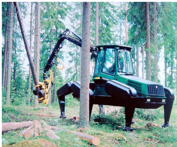
Slika 19: Revolucionarni Plustech Walking machine na demonstraciji leta 1996 (Drushka / Kontinen, 1997)
