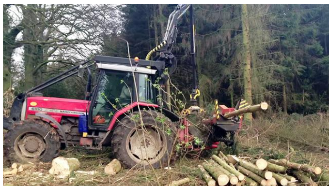
Slika 30: Procesor Nokka 400 RS z dvema procesorskima glavama priključen na traktor (James Sharp Youtube kanal, 2016)
