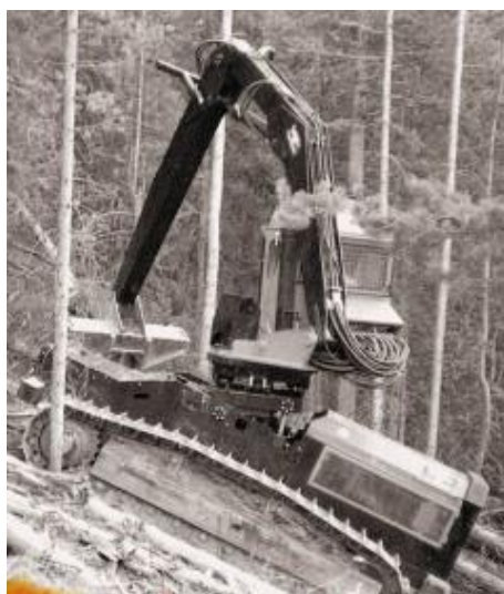
Slika 15: Inovativno 2-smerno niveliranje strojniške kabine (TimberPro History, 2016)
