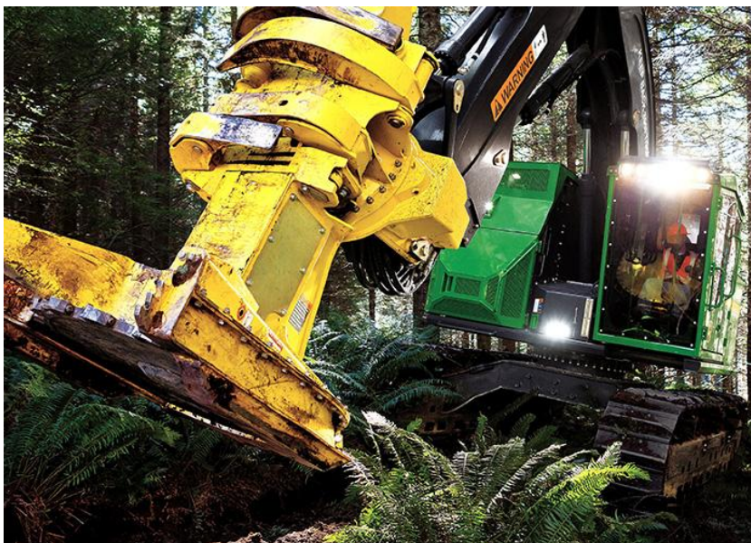
Slika 27: Krožna žaga na glavi za podiranje in zbiranje lesa (John Deere, 2016)
