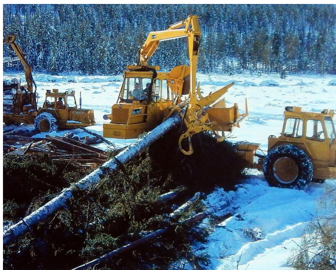
Slika 8: Prodajni uspešnici svojega časa, zgibni polprikoličar Volvo 868 z nameščenim procesorjem Ösa 710 (Drushka in Kontinen, 1997)
