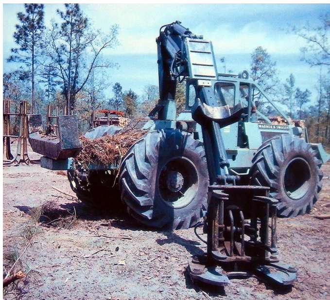
Slika 6: Stroj za podiranje in spravilo (feller skidder) iz leta 1968 imenovan Log All, Quebec, Kanada (Drushka in/ Kontinen, 1997)
