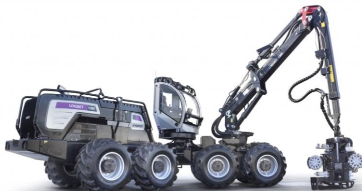
Slika 49: Hibrini harvester LOGSET 12H GTE je z močjo 380 kW trenutno najmočnejši sečni stroj na trgu (VISED, 2016)
