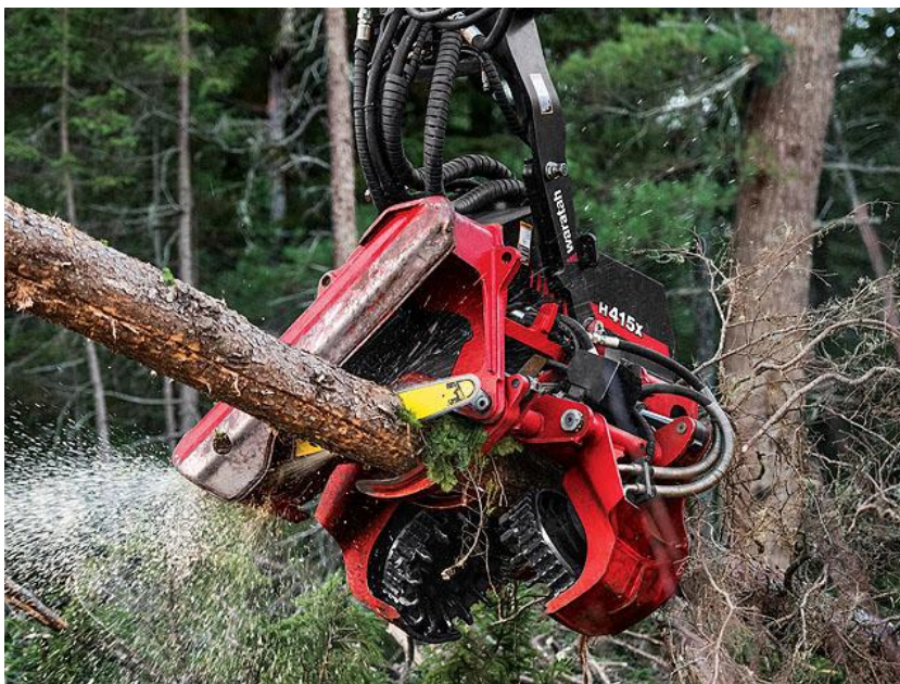
Slika 26: Harvesterska glava z verižno žago na hidro-pogon (Waratah, 2016)
