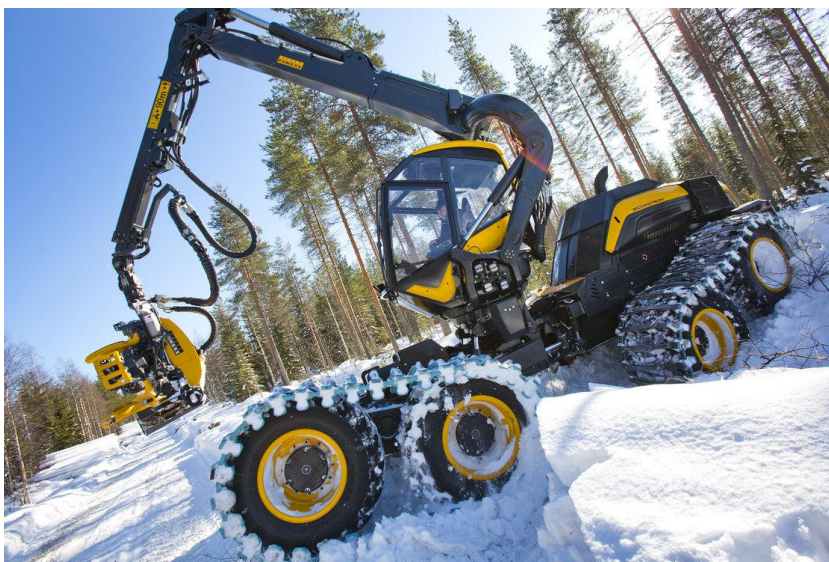
Slika 22: Specialni harvester Ponsse Scorpion (Ponsse, 2016)
