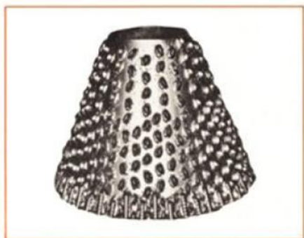
Slika 14: Stožčasti podajalni valji na procesorju stroja Volvo 900 (Solhem 9, 2016)
