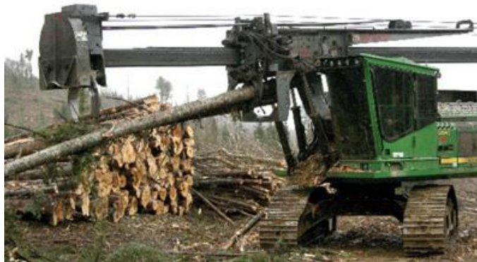
Slika 35: JohnDeere 2154 z Pro Pac agregatom za kleščenje (John Deere spletna stran, 2016)
