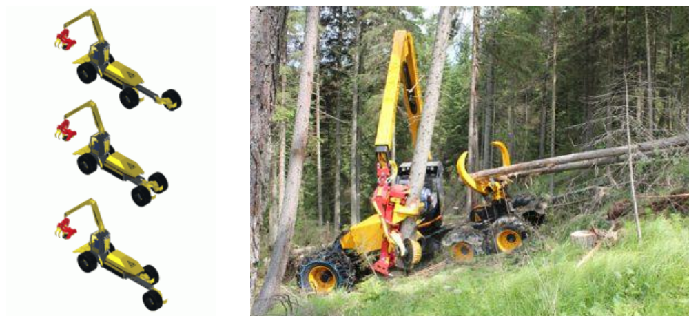
Slika 33: Raztegljiva kolesna platforma stroja Highlander za prilagajanje terenskim razmeram (levo) in prikaz funkcije sečnje in spravila na strmih terenih (desno) (Forsttechnik, 2016)
