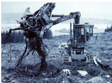
Slika 37: Ösa 670 z namensko glavo za ruvanje panje (Drushka in Kontinen, 1997)
