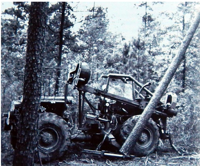
Slika 3: Busch Combine leta 1959 razvit v Louisiani (ZDA) za potrebe podiranja in obdelave celuloznega lesa (Drushka in Kontinen, 1997)
