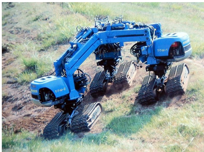
Slika 18: Prototipni Tri-Track Mover je omogočal delo na strmih in zaradi odlične prehodnosti tudi skalovitih terenih (Drushka in Konttinen, 1997)
