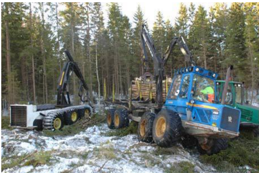
Slika 20: The Beast daljinsko vodeni harvester v delovni skupini z dvema forwarderjema (Skogforsk, 2006)
