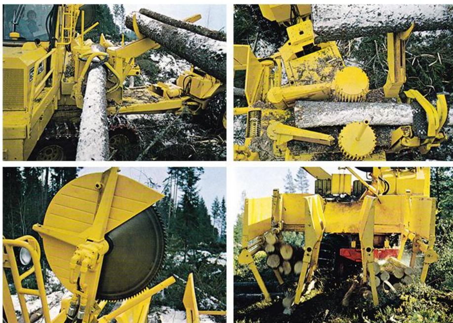
Slika 10: Ösa 710 procesor s prikazanimi glavnimi funkcijami (Ösa arhiv, 2016)
