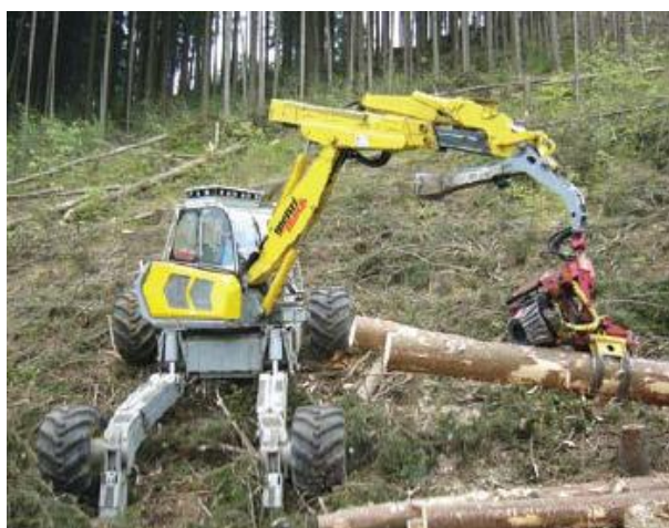
Slika 40: Švicarski Menzi Muck A91 z glavo Woody 50 (Menzi Muck, 2016)
