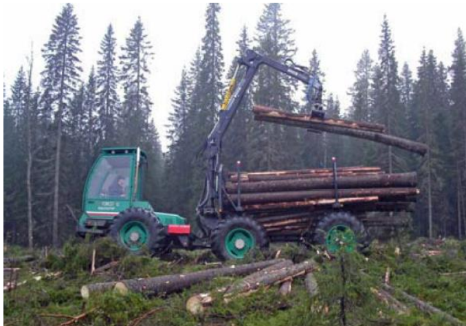
Slika 48: El-Forest hibridni forwarder (Bergkvist in sod., 2007)
