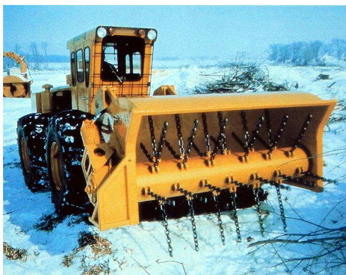
Slika 12: Hydro-Ax verižni stroj za kleščenje iz leta 1972, Manitoba, Kanada (Drushka in Kontinen, 1997)
