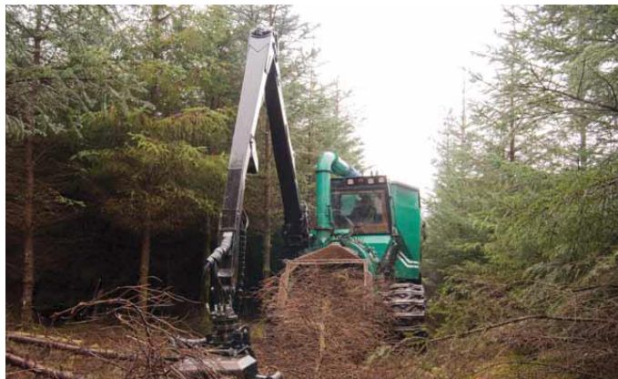
Slika 36: Silvatec sekalni harvester na polgosenicah namenjen za pridobivanje biomase (Silvatec spletna stran proizvajalca, 2016)
