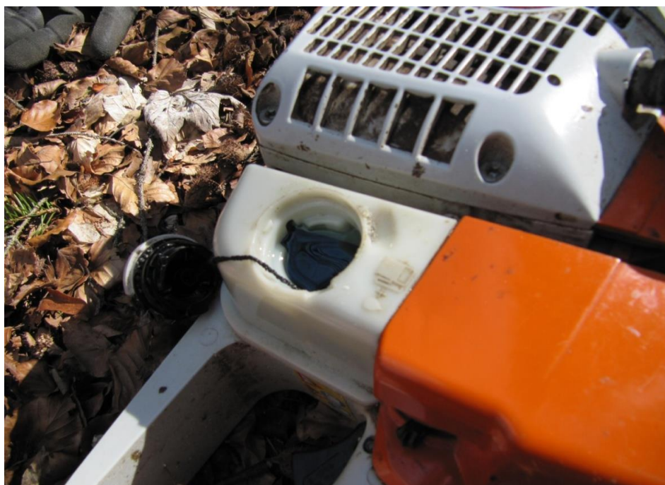
Slika 5: Prikaz nivoja polnjenja posode za gorivo pri motorni žagi STIHL MS 361 (Foto: Nejc Gorišek)
