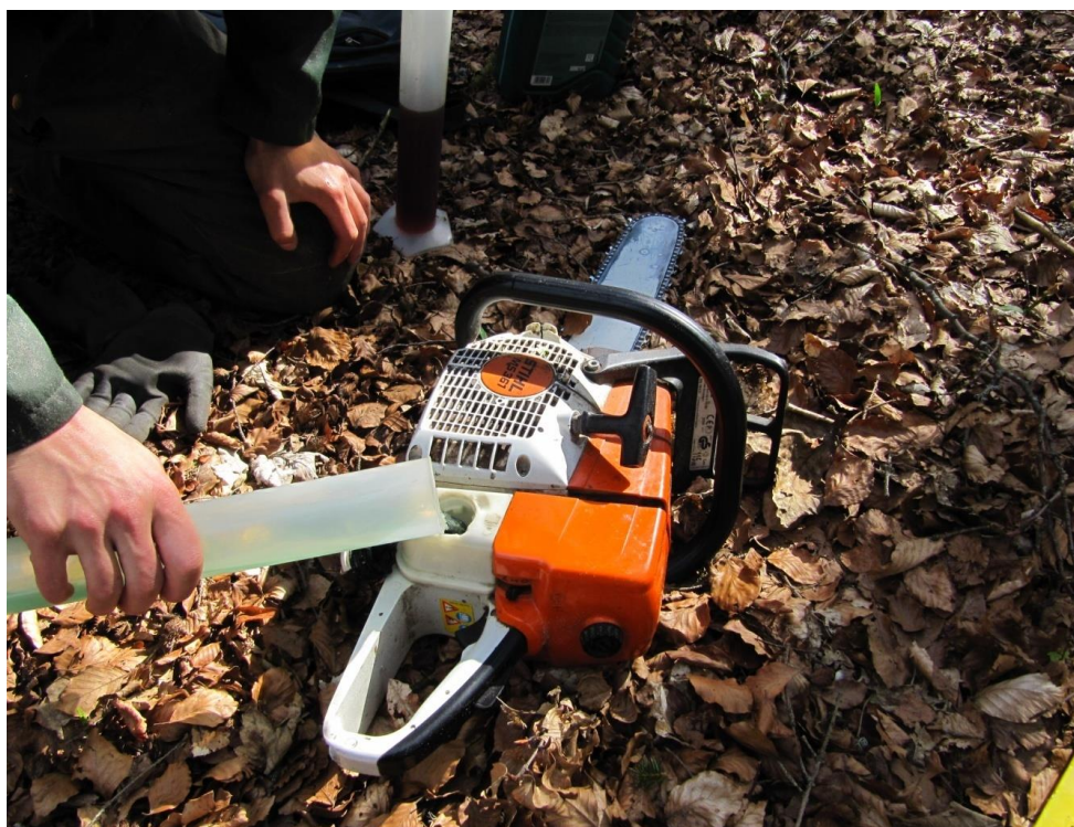
Slika 4: Uporaba merilnih valjev pri odčitavanju porabe goriva in maziva (Foto: Nejc Gorišek)
