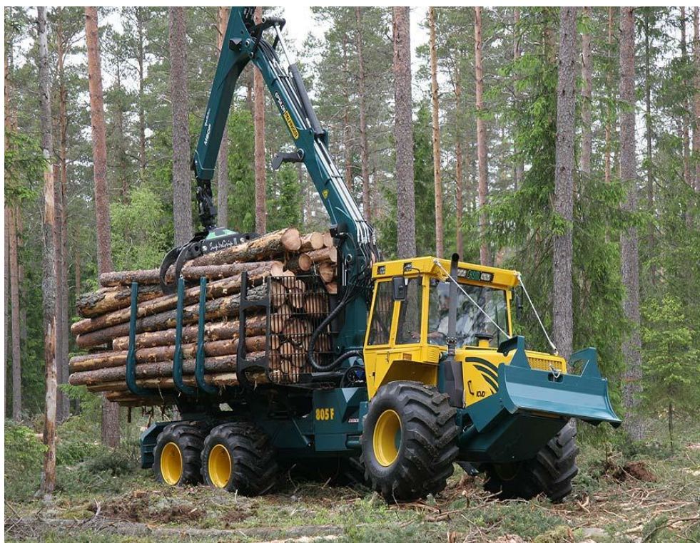
Slika 3: Kombinirani stroj HSM 805F Kurzchassis zbira in odvažata sortimente, do dolžine 7 metrov
