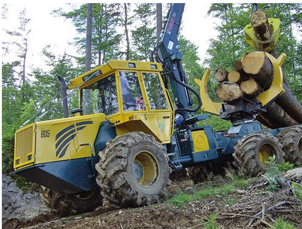
Slika 2: Kombinirani stroj HSM 805F v obliki sedlastega traktorja pri spravilu dolgega lesa
