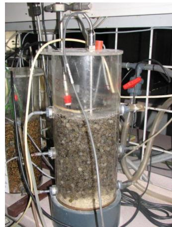
Slika 6: Mini reaktor CČN s pH regulacijo (Hach-Lange), napoljen z nosilci Kaldnes K1
