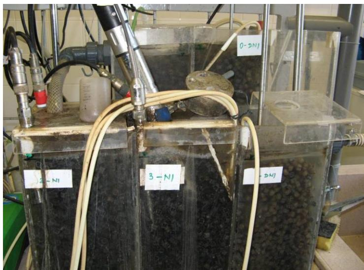
Slika 8: Slika mini reaktorja CČN
