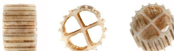
Slika 2: Fotografija poraščenosti polietilenskega nosilca s pritrjeno biomaso
